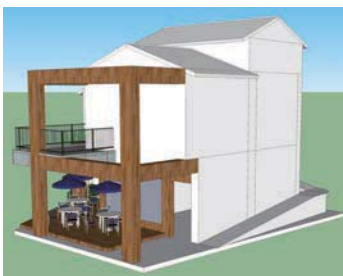
入口處頂板雨遮與銜樑設計；自然形成遮陽與外部玄關概念
