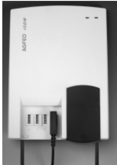
Abb. 5: TK-Anlage mit gesteckter Stromversorgung, ISDN-Anschluss und TAE-Stecker
