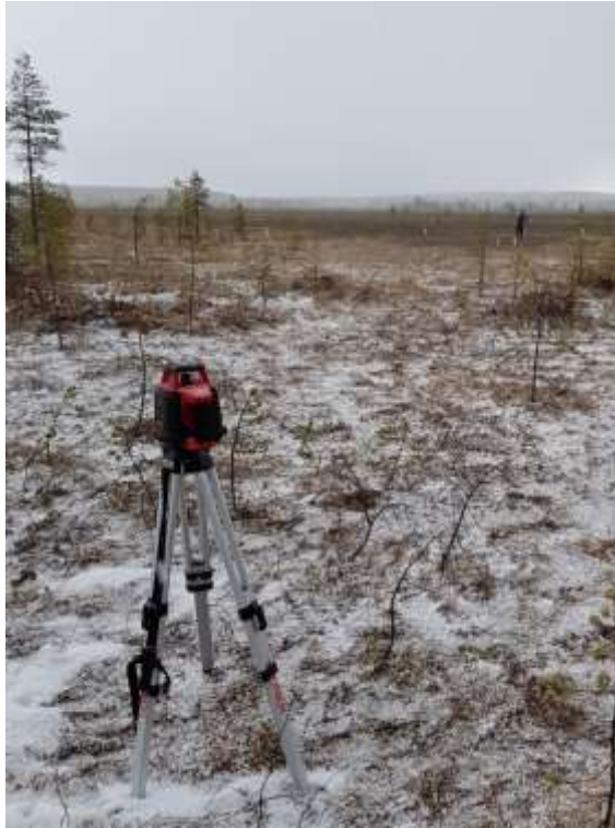
Kuva 3. Tasolaserin päällä pyörii majakka, jonka lasersäde säätyy automaattisesti vaakatasoon. Kunkin sijainnin korkeuslukema saadaan vastaanottimen ja mittalatan avulla. Korkeusero saadaan selville vertailemalla eri sijaintien korkeuslukemia keskenään.
