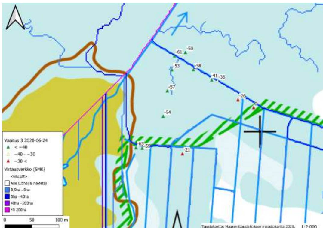
Kuva 16. Vaaitus 3. Ojat voi padota vaaituslukemien -61 ja -21 kohdilta, jotta vettymishaittoja ei synny ja jotta vettä saadaan palautettua mahdollisimman paljon suolle. Vaaituksen lukemat ovat senttimetrejä ja negatiivinen suunta on alaspäin.
