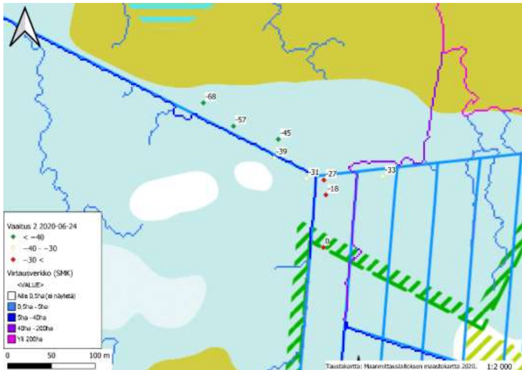
Kuva 15. Vaaitus 2. Suojelualueen raja on asetettu nollassa. Vaaituksen lukemat ovat senttimetrejä ja negatiivinen suunta on alaspäin.
