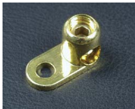
23025 Massekabelschuh für 20 mm 2 Massive Anschlussklemme mit Inbusschrauben für den Anschluss von Massekabeln. Lochdurchmesser = 8,5 mm.
