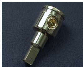
23033 Reduzierstück für 70 mm 2 Ermöglicht den Anschluss von 70 qmm Powerkabel an Verteilerblockeingänge bis 20 qmm.
