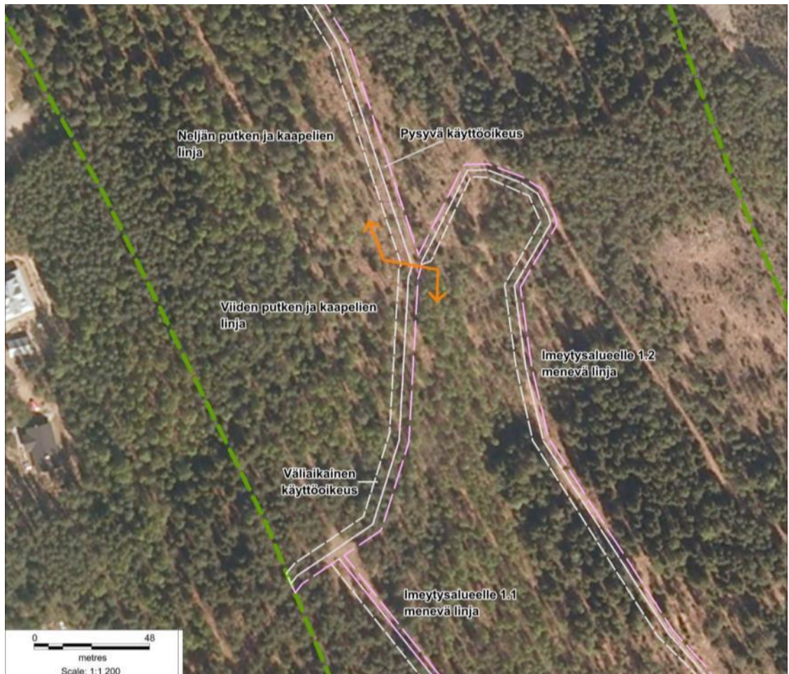
Kuva 38. Raikun vedenottamolle menevä siirtoputki- ja painelinja rakennetaan olemassa olevalle kulku-uralle, samoin siirtolinjat imeytysalueelle IA 1.1 ja IA 1.2. Ilmakuvaotos on linjan eteläosalta.
