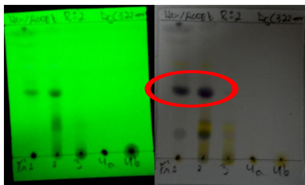
Figura 21: CCD das frações DgPa a) revelador UV de 264 nm e b) revelador vanilina sulfúrica.
