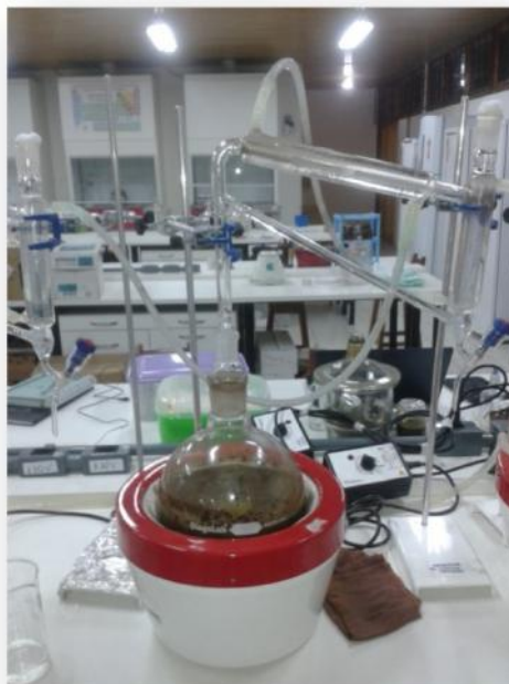
Figura 16: Extração dos óleos essenciais de O. amazonicum em um aparelho tipo Clevenger modificado.
