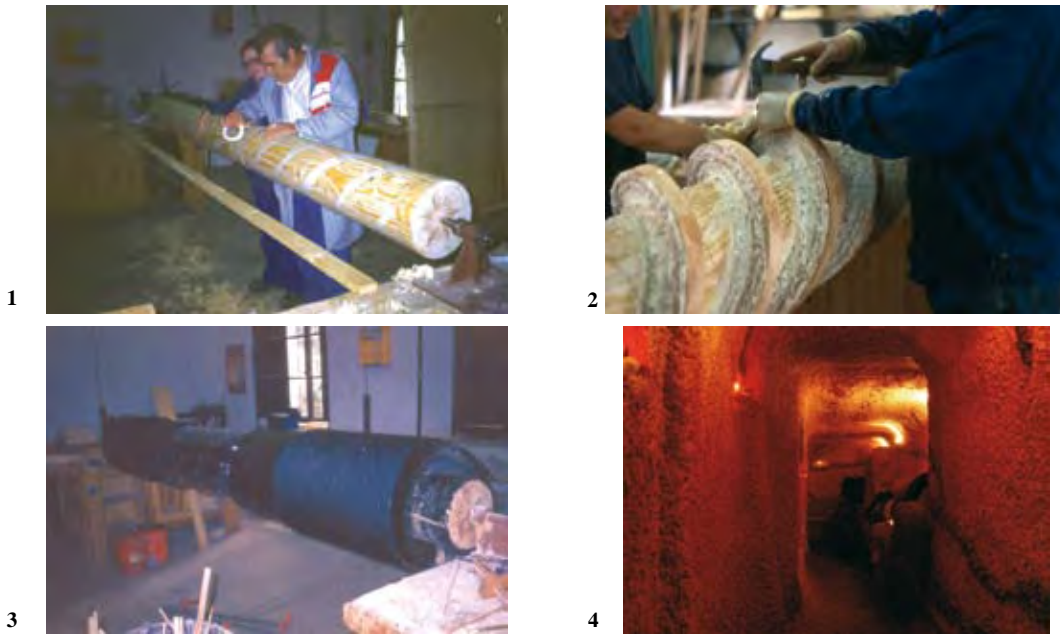
Tornillos de Arquímedes reproducidos a escala 1/1 con medidas reales tomadas de Vitrubio. Proceso de construcción (1, 2 ,3) Foto AFRT. Ubicación a la salida de la Reproducción de Mina Romana. Foto Aragón.
