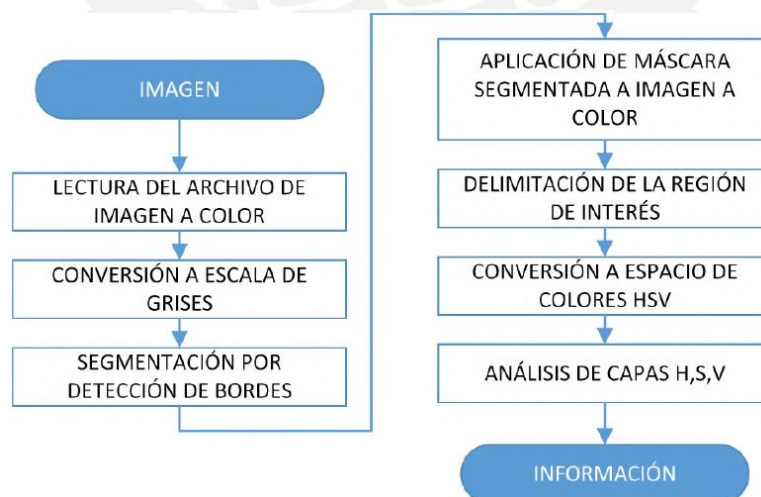
Figura 1-46. Algoritmo de clasificación de arándanos propuesto en la tesis de Takao Shimabukuro 22 .
