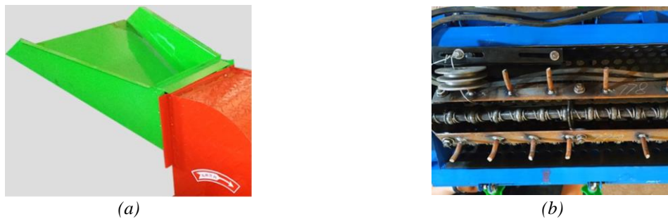
Figura 1-16. Mecanismo de desgrane de la máquina MX1200 11 . (a) Tolva de alimentación de máquina MX1200. (b) Mecanismo de desgranado de máquina MX1200.
