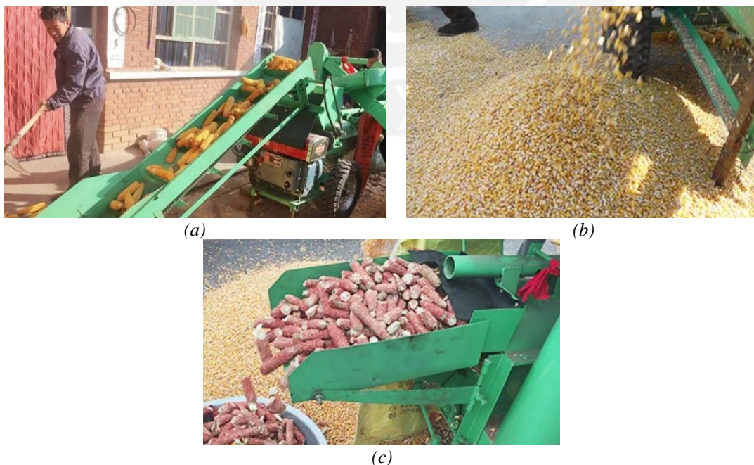
Figura 1-14. Mecanismo de carga y descarga de la máquina TY-80D 10 . a) Sistema de alimentación automático. b) Descarga del maíz desgranado. c) Descarga de las corontas por vibración.
