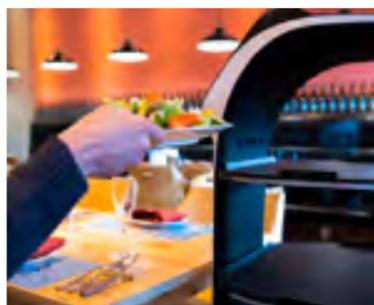
+ Ist der Rundfahrmodus aktiviert, kann BellaBot unterschiedliche Tische anfahren und die Bestellung an die Gäste ausliefern. Der Gast nimmt die Bestellung eigenständig entgegen und der Roboter fährt zurück zur Küche.
