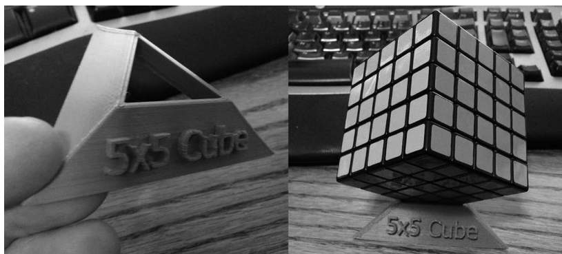
圖3.1. 作者在早期材料擠壓成型印表機上設計的，3D立體列印支架。
