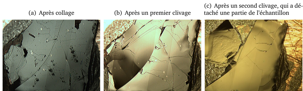
FIGURE 3.8 – Clivage d'un échantillon de Bi-2212 (la couleur provient de l'éclairage et n'est pas liée à la qualité de la surface)
