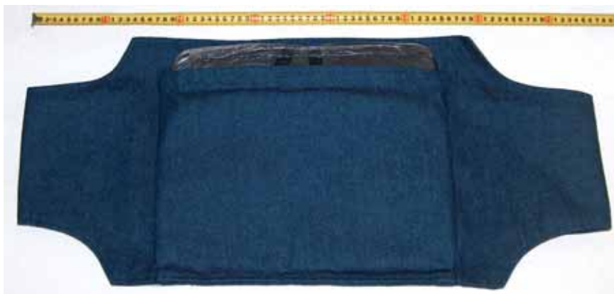
Σχήμα 2-9. Το γιλέκο WAAV (Wearable Absorbing Abdominal Vest) που χρησιμοποιήθηκε για την καλύτερη μηχανική προσαρμογή του μετρητικού βιοακουστικού συστήματος.
