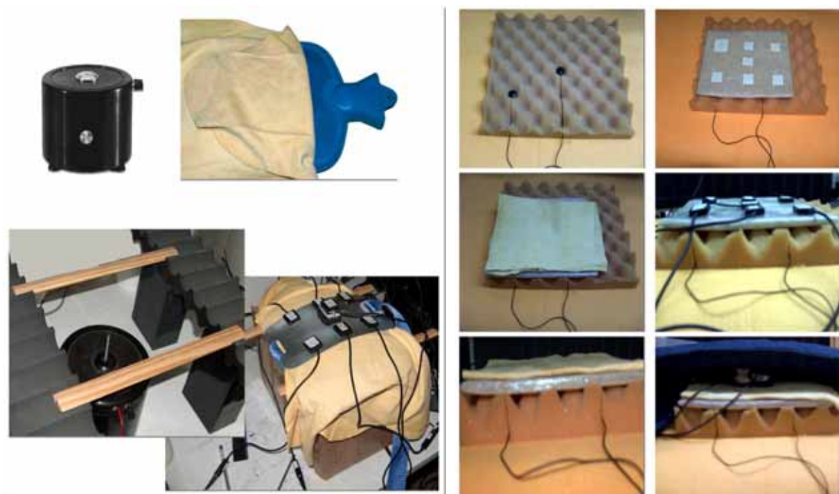
Σχήμα 6-7. Πειραματικές διατάξεις αξιολόγησης της μεθόδου ηχητικού εντοπισμού DEBL .
