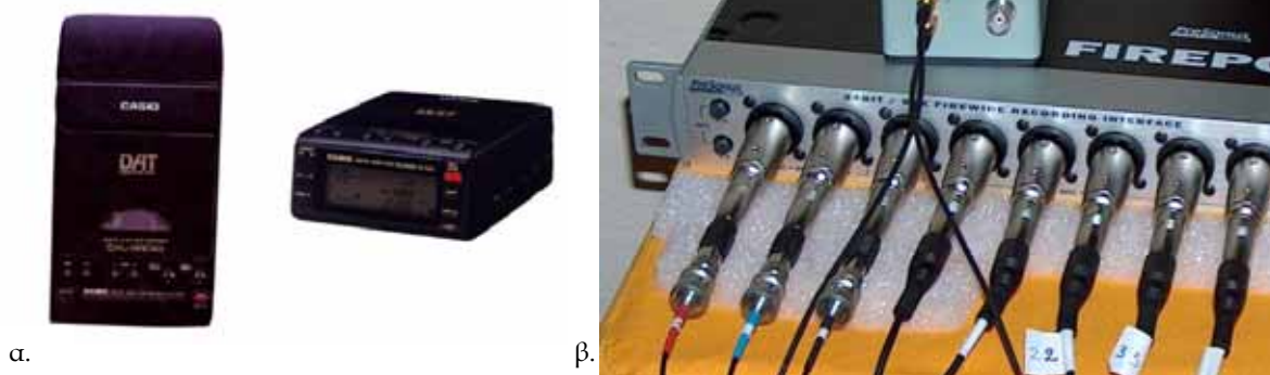
Σχήμα 2-13. α. Φορητό σύστημα στέρεο-ηχογράφησης DAT, DA-R100, CASIO, β. πολυκαναλική κάρτα ήχου PreSonus FIREPOD - 24-bit/96K FireWire Recording Studio, σε στιγμιότυπο πειραματικής εφαρμογής.
