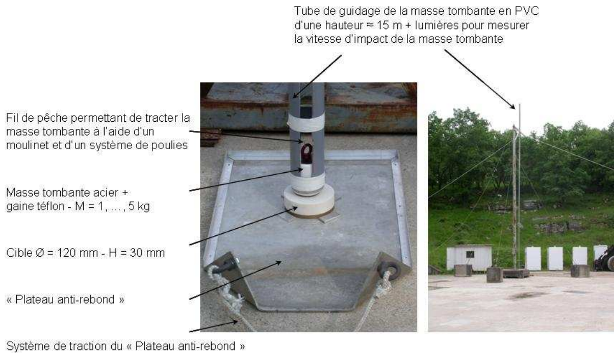
Figure 97 – Dispositif tour de chute grande dimension
