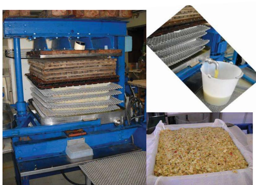
**Figure 44 - Photographie de la presse à paquets utilisée pour produire les jus de *Dous Moen* en grand volume<sup>5</sup>**
