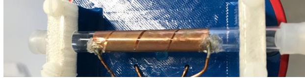
Figure 117: Photographie de la bobine solénoïde avec le fil en forme de ruban
