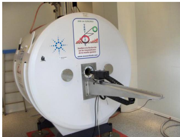
Figure 75: IRM 9.4 Tesla de la plateforme BioNanoMRI. Le champ magnétique de l'IRM 9.4T est environ 200 000 fois supérieur au champ magnétique terrestre.
