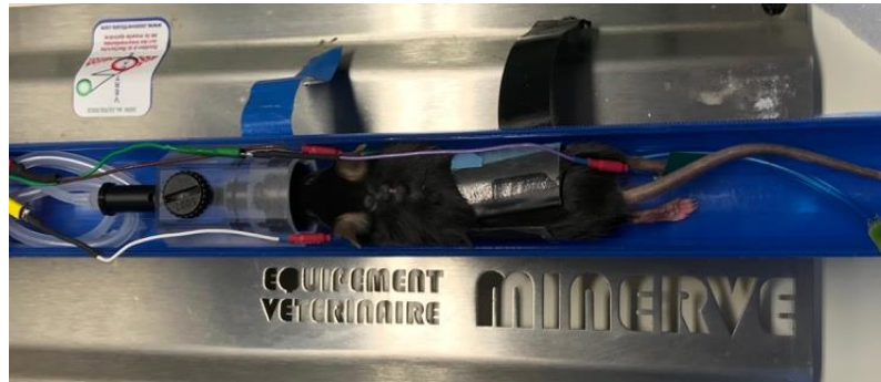
Figure 75 : Mise en place d'une souris dans le banc d'anesthésie. Le banc d'anesthésie permet de mesurer la température, la fréquence cardiaque et la fréquence respiratoire (Minerve Siemens)
