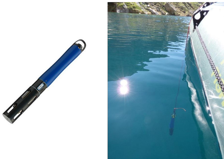
Figure 3-9: EXO2 multiparametric probe.
