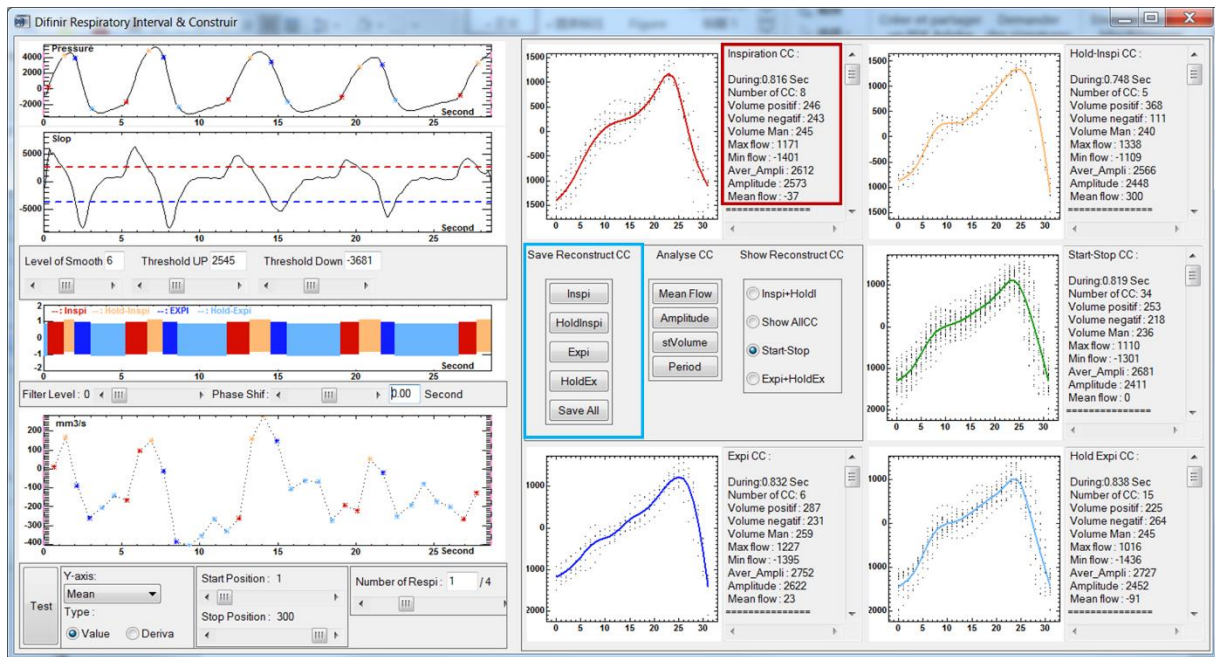
Figure 5-45 L'interface de l'algorithme II. Le CDCC moyen pour chaque intervalle respiratoire et ses paramètres sont affichés (cadre rouge) dans le panneau des résultats sur le côté droit, et ces paramètres peuvent être enregistrés dans un fichier texte en utilisant le bouton sauvegarder (cadre bleu).
