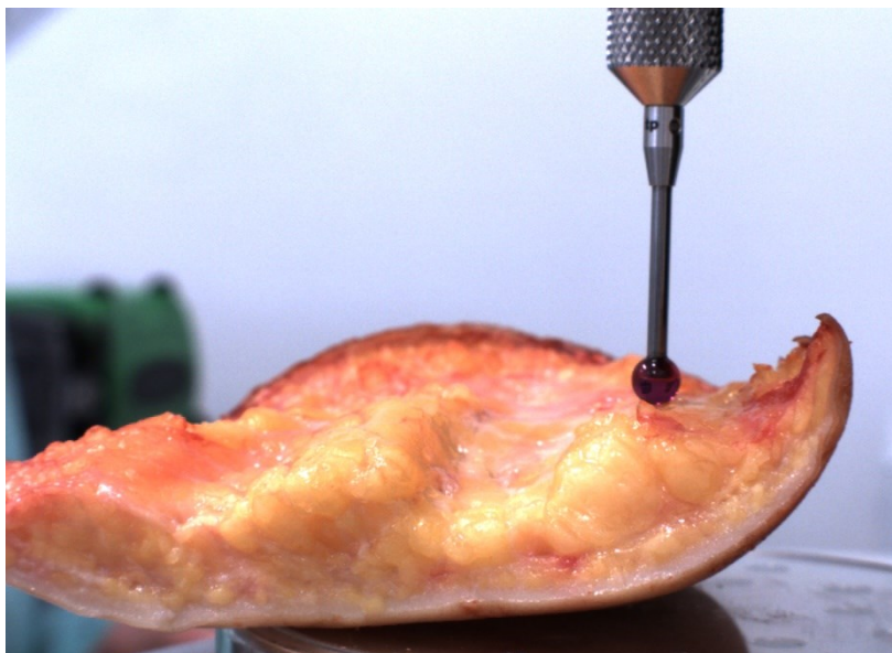
Figura 26. Heel pad mediale del paziente SLA30101966 soggetto a prova di indentazione con induttore sferico.
