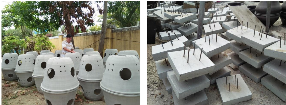
Hình 3-10. Chậu và tấm bê tông sử dụng phục hồi rạn san hô ở Sơn Trà
