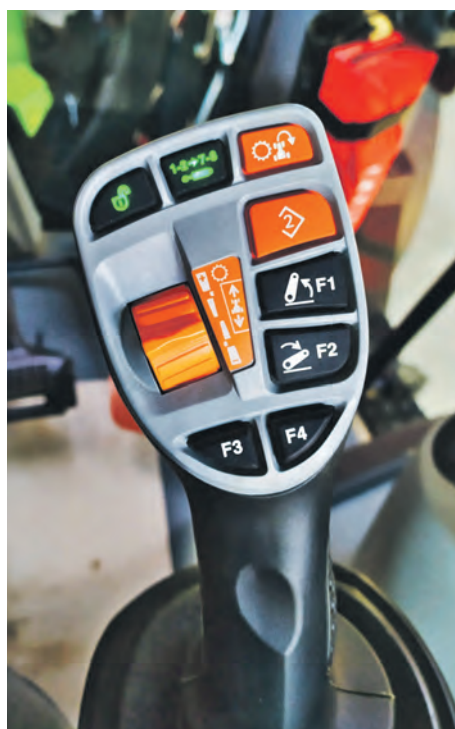
Joystick ElectroPilot-(l.) und Multikuppler (r.) erleichtern die Bedienung und Montage.
