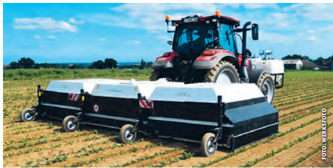
Die Feldspritze ARA appliziert punktgenau nach Bedarf.
