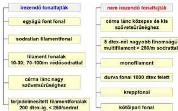
Az írezés szükségessége kelmeképzéshez
