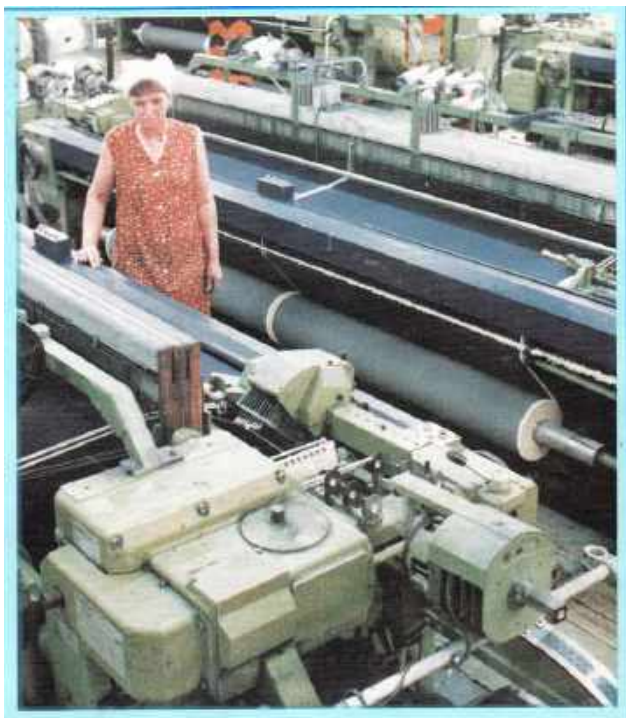
4. kép. Farmerszövet szövése ragadókaros szövőgépen
