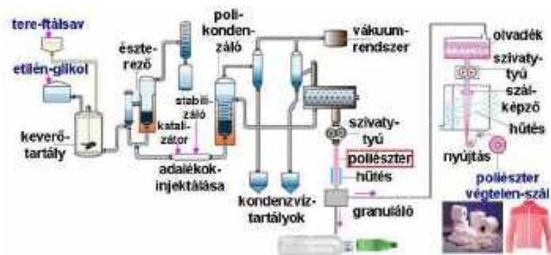
3. ábra. Az új előállítású poliészter képzése
