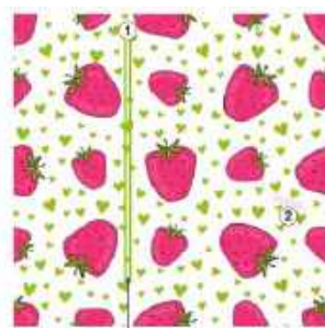
itt került szennyeződés a nyomókés alá, ami azt megemelte Hosszú színezékcsik (1) és krómleválás (2) a hengernyomásnál
