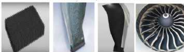
Többrétegű szövet szerkezete Ventilátor lapát preform kialakítása Kész CFRP ventilátor lapát Ventilátor
