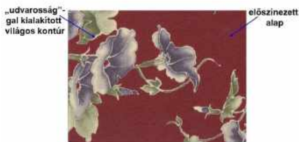
Példa a marópép tudatosan előidézett, mintalemen túlterjedő hatására
