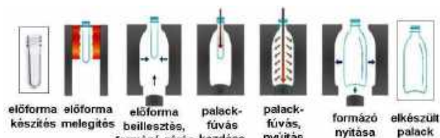
2. ábra. A PET-palack gyártási folyamata
