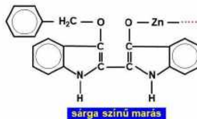
Cinkoxid jelenlétében a Leukotrop O-val a leukoindigón sárga marástermék keletkezik
