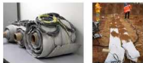
Jeladásra és továbbításra alkalmas optikai szálakból, nanokristályos piezoérzékelő szálakból felépülő textilszerkezet és elhelyezése
