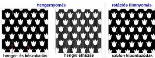
Néhány példa a marónyomásnál bekövetkező hibákra, ha nem alkalmaznak Tekagolos telítést ill. védődeckert
