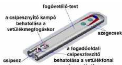
5. ábra A fogó (mikro) vetelő felépítése
