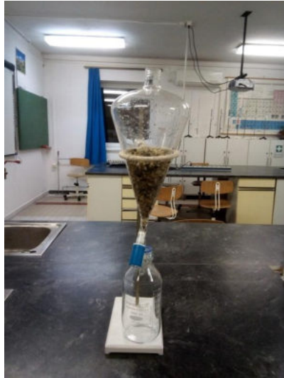
1. Kép: Kavicsszűrő két szemcsemérettel. Készítette: Parrag Tamás
