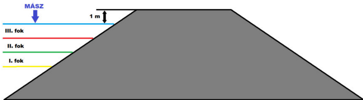
2. kép, A Telephely Hidrológiai jellemzés és árvízvédelmi jegyzet előírás szerint kialakított árvízvédelmi töltés a mértékadó árvíz-szint jegyzet alapján szerkesztett kép, 20. old. 4.2.5-3 táblázat, készítette: a szerző
