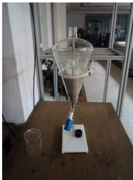
2. Kép: Homokszűrő kavics támasztóréteggel Készítette: Parrag Tamás
