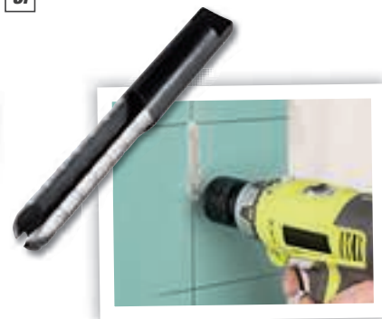
3. Fräsbohrer für Gipskarton * / ** Zum Fräsen von Konturen und Bohren von Löchern, z. B. für Gipskartondübel, 3 Schneiden mit Spanbrechnuten sorgen für einen schnelleren Fräsfortschritt, Arbeitsbereich 35 mm, 8 x 70 mm, Schaft Ø 8 mm. Art.-Nr. 1251007
