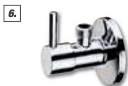
6. Design-Eckventil 1/2" Ohne Verschraubung, zum direkten Anschluss von Flexschläuchen 3/8", Innenoberteil mit Keramikscheiben, Drehwinkel 90°, Schubrosette, AG, 3/8" IG-AG, Ø 10 mm, Messing, verchromt, Art.-Nr. 5467066 12.99
