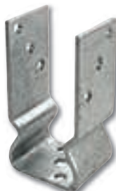
7. Pfostenträger Zum Aufschrauben, mit Sicke, feuer- verzinkt. Maße: 91 x 150 x 60 mm (B x H x T) Art.-Nr. 1728860
