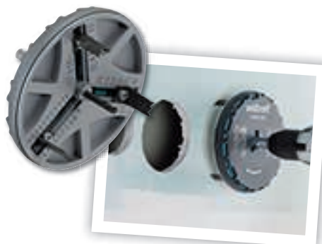
2. Lochsäge „AH 40-130“ * / ** Für Gipskartonplatten, OSB-Platten, Weichholz, Sperrholz, Spanplatten. Feine und saubere Schnitte durch spezielle Zahngeometrie, 3 integrierte Skalen für alle üblichen Maße, geschützter Arbeitsbereich durch großen Bohrteller, zuverlässige Staubabfuhr für dauerhaft funktionsfähige Stellmechanik. Schnitttiefe 30 mm. 20 x 27,5 x 4,5 cm (B x H x T) Art.-Nr. 1750376
