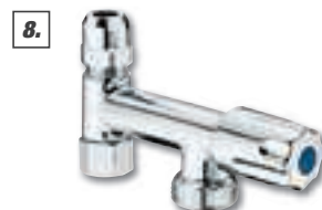
8. Maschinen-Anschlussventil „Eckfix“ Mit Rückflussverhinderer und Längenausgleichverschraubung. Zum einfachen Anschluss einer Wasch-/Spülmaschine an ein bereits vorhandenes Eckventil, 3/8" Innengewinde, Quetschverschraubung 1/2" Innengewinde x Ø 10 mm, 3/4" Außengewinde, Messing verchromt, Art.-Nr. 5462413 16.99
