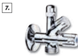
7. Maschinen-Eckventil 1/2" Mit Rückflussverhinderer, ermöglicht den Anschluss einer Wasch-/Spülmaschine, sowie den Kaltwasseranschluss einer Armatur. Beides separat absperrbar, mit Längenausgleichverschraubung und Rosette, 1/2" Außengewinde, Quetschverschraubung Ø 10 mm, 3/4" Außengewinde, Messing verchromt, Art.-Nr. 5462391 19.99
