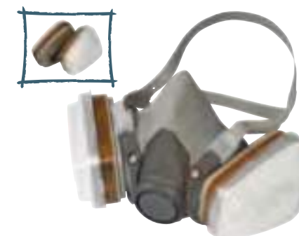
Maske für Farbspritzarbeiten „6002C“ Mehrwegmasken-Set für effektiven Schutz vor gesundheitsgefährdenden Gasen, Dämpfen und Partikeln bei Farbspritz-, Farbstreich- und Maschinenschleifarbeiten, Schutzstufe A2P2, Doppelfiltersystem, Ausatemventil, Bajonett-Klick-Anschluss für unkompliziertes Filterwechseln (1 Maskenkörper, 1 Paar Gasfilter, 1 Paar Partikelfilter, 1 Paar Filterdeckel), Art.-Nr. 1400770 49,99 Filter für Farbspritzarbeiten „6002CR“ Art.-Nr. 1400771 29,99
