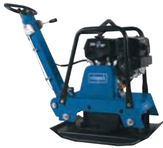
Rüttelplatte „HP3000S“* Plattengröße 730 x 450 mm, reversierbar, Verdichtungsdruck 30.500 N, Verdichtungstiefe 50 cm, 9,0 PS, 4-Takt-Benzinmotor, mit Fahrvor- richtung und PU-Schutzmatte, Art.-Nr. 1501116 999,-
