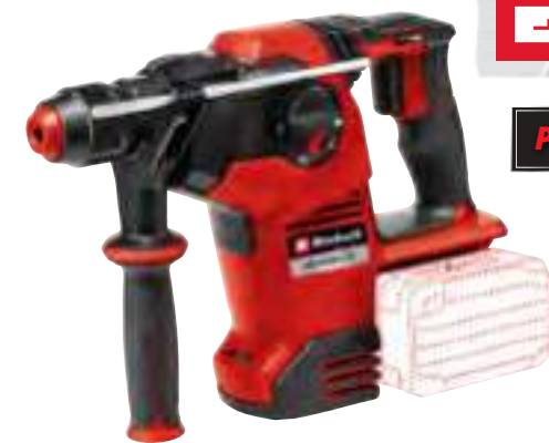
Akku-Bohrhammer „Herocco 36/28“ Bohren/Hammerbohren/Meißeln mit und ohne Fixierung, Vibrationsdämpfung, bürstenloser Motor, SDS-plus-Aufnahme, mit LED-Licht zum Ausleuchten des Arbeitsbereichs, Akku 36 V: Leerlaufdrehzahl (Gang 1) 0 - 1.100 min -1 , Schlagzahl (Gang 1) 0 - 5.300 min -1 , Schlagstärke 3,2 J, max. Drehmoment hart 29 Nm, Bohrleistung in Beton 28 mm, ohne Akku / Ladegerät, inkl. Transport- und Aufbewahrungskoffer E-Box, Art.-Nr. 1490543 259,99
