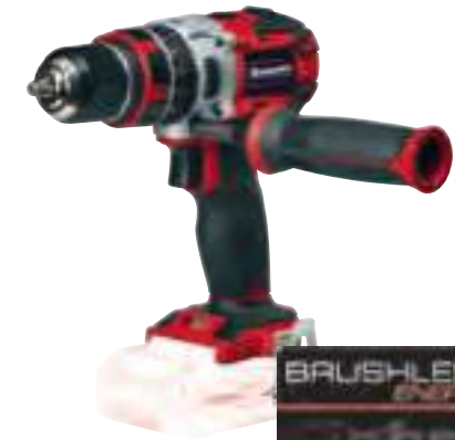
Akku-Schlagbohrschrauber „TE-CD 18 Li-i BL“ – Solo bürstenloser Motor, 2-Gang-Getriebe, max. Drehmoment hart 60 Nm, Bohrleistung in Beton 10 mm, Schlagzahl max. 0 - 28.800 min -1 , ohne Akku / Ladegerät, 22 Drehmomentstufen, max. Leerlaufdrehzahl 0 - 1.800 min -1 , Art.-Nr. 1501359 82,99
