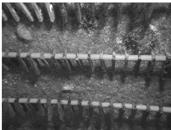
図4-2-4 全ねじボルトに通し、枠に固定された着生板
