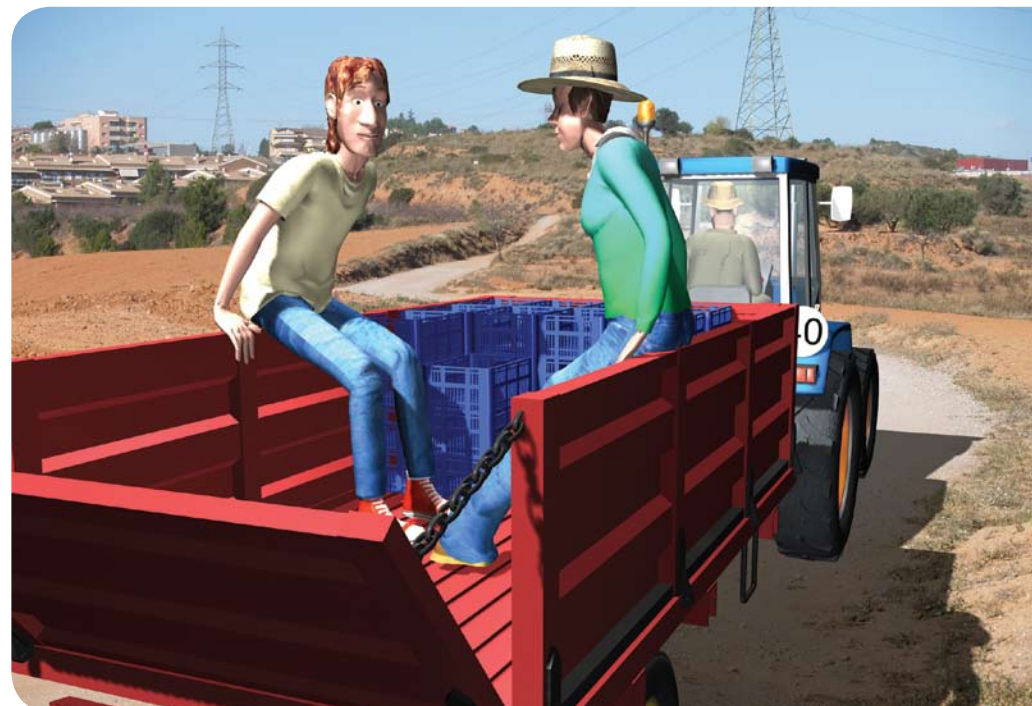
No utilitzeu el remolc per al transport de persones si no disposa d'un seient específic
