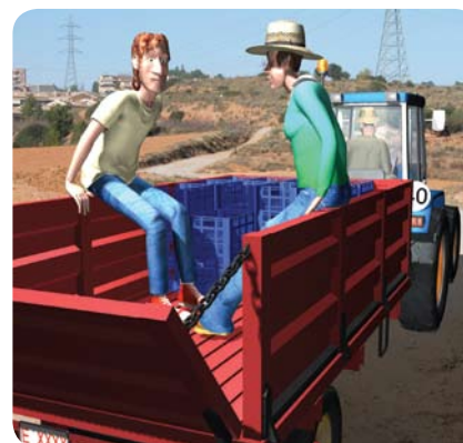
No utilizéis el remolque para el transporte de personas si no dispone de un asiento específico
