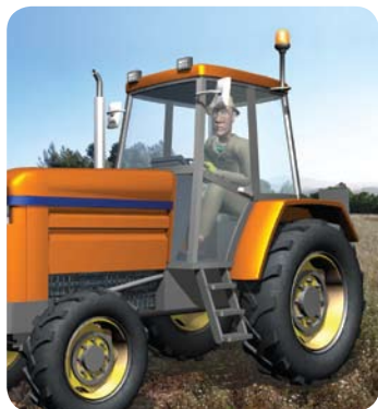
Para evitar cogidas por vuelco de tractor, debe disponerse de una estructura antivuelco como la cabina o el arco antivuelco
