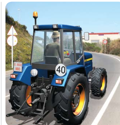
Es muy importante que el tractor lleve la señalización luminosa giratoria intermitente cuando circule por vías públicas
