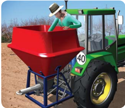
يجب عدم التلاعب أو تقليب الطوب المحشور داخل قمع التلقيح بواسطة اليد قبل إطفاء الماكينة
