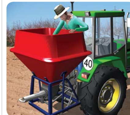
No manipuléis ni deshagáis con la mano el abono apretado del interior de la tolva sin haber desconectado previamente la toma de fuerza
