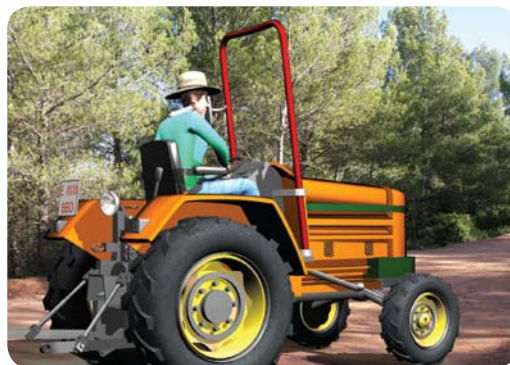
Afin d'éviter d'être accroché en cas de renversement du tracteur, il faut disposer d'une structure anti-renversement, par exemple la cabine ou l'arc anti-renversement
