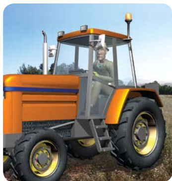
Afin d'éviter d'être accroché en cas de renversement du tracteur, il faut disposer d'une structure anti-renversement, par exemple la cabine ou l'arc anti-renversement
