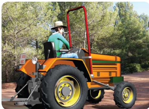
Para evitar cogidas por vuelco de tractor, debe disponerse de una estructura antivuelco como la cabina o el arco antivuelco
