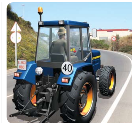
Il est donc très important que le tracteur porte la signalisation lumineuse, giratoire et clignotante, lorsqu'il circule sur des voies publiques
