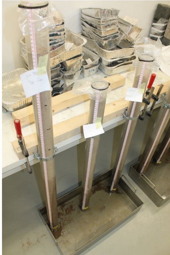
Kuva 63. Kapillaarisen nousun määrittäminen putkessa.
