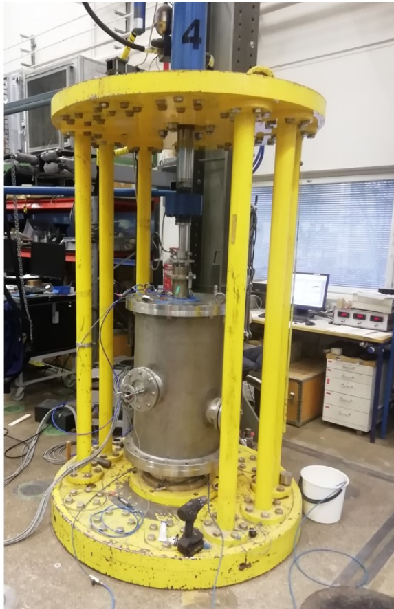
Kuva 67. Kokeissa käytetty kolmiakselialikoelaitteisto.
