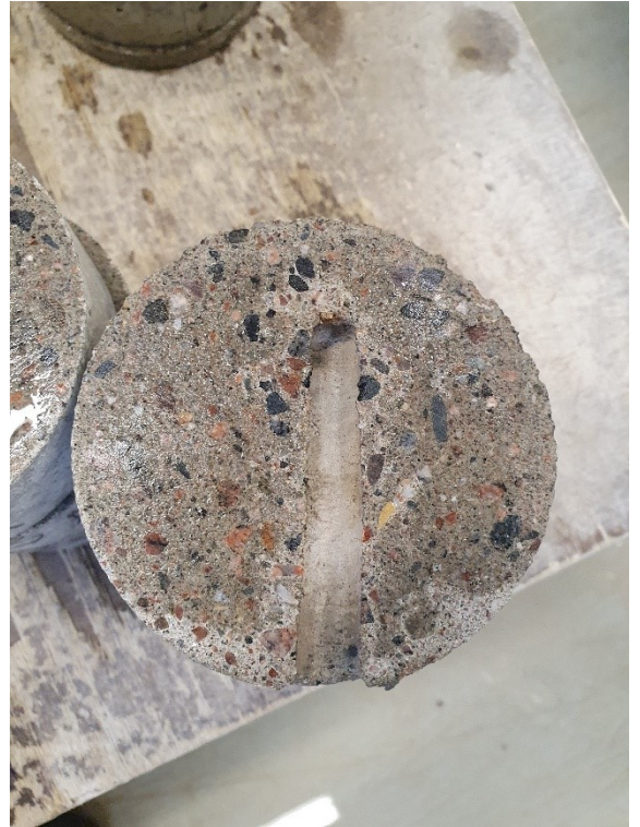
Kuva 36. Aquastop:n injektointikohta viiden viikon imeytymisen jälkeen.
