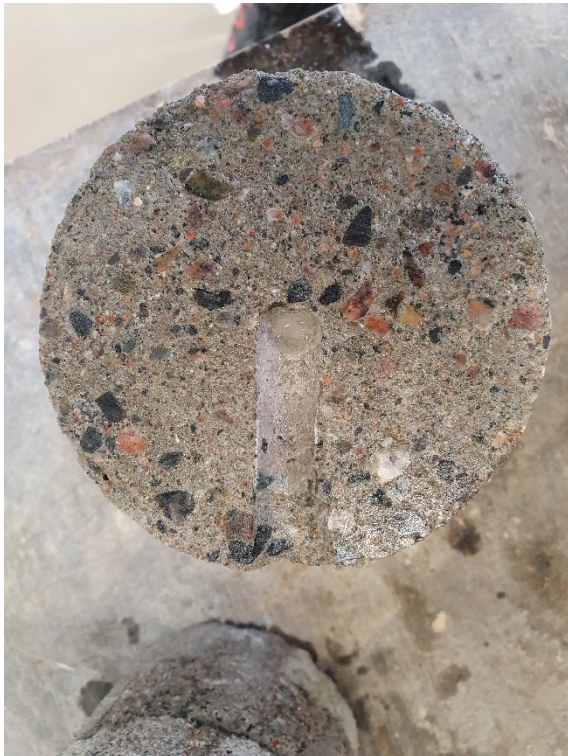
Kuva 39. Köster Crisin 76 Concentrate:n injektointikohta viiden viikon imeytymisen jälkeen.
