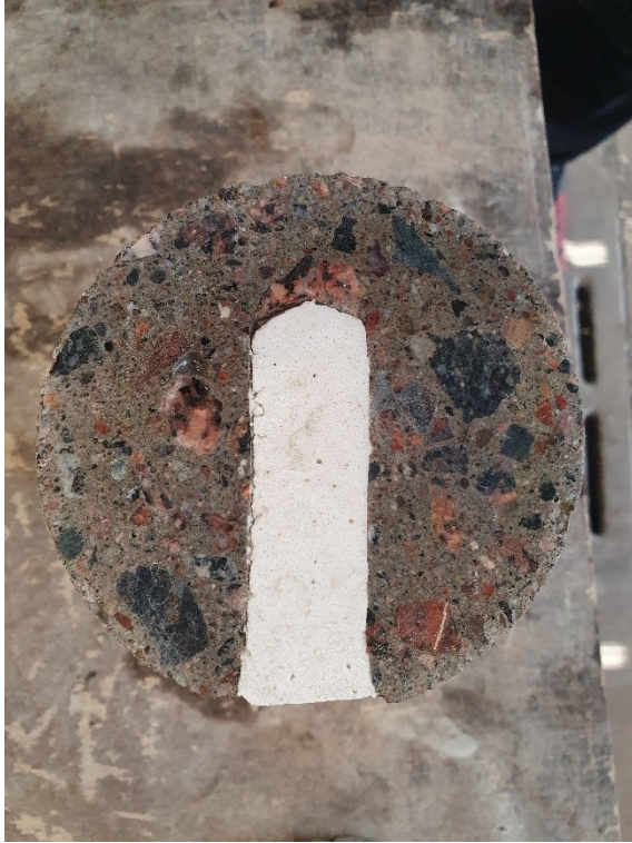
Kuva 37. Xypex Concentrate:n injektointikohta viiden viikon imeytymisen jälkeen.
