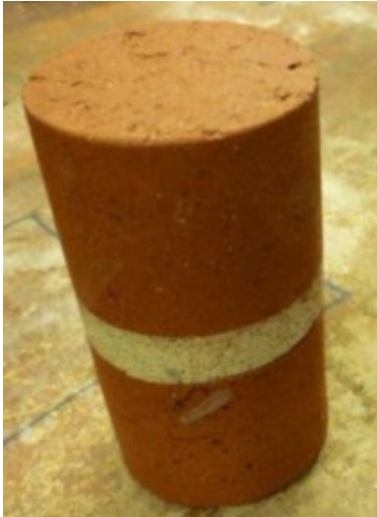
Kuva 28. Tiilirakenteesta porattu lieriönäyte, jossa on keskellä muuraussauma [49].
