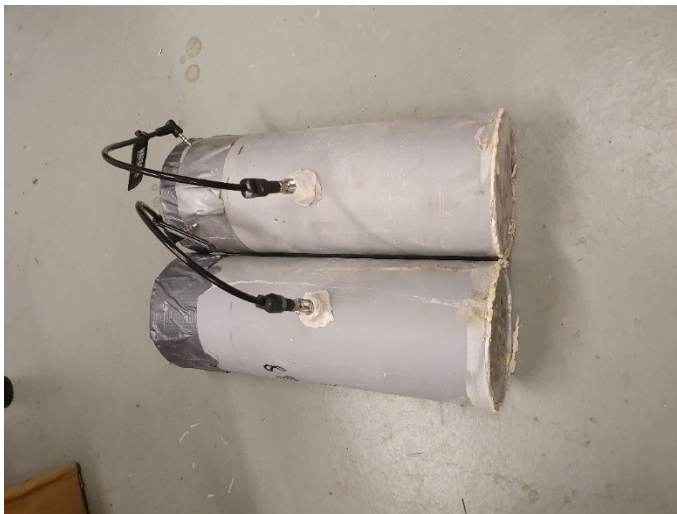
Kuva 44. Koekappaleiden porareikiin asennetut mittapäät.
