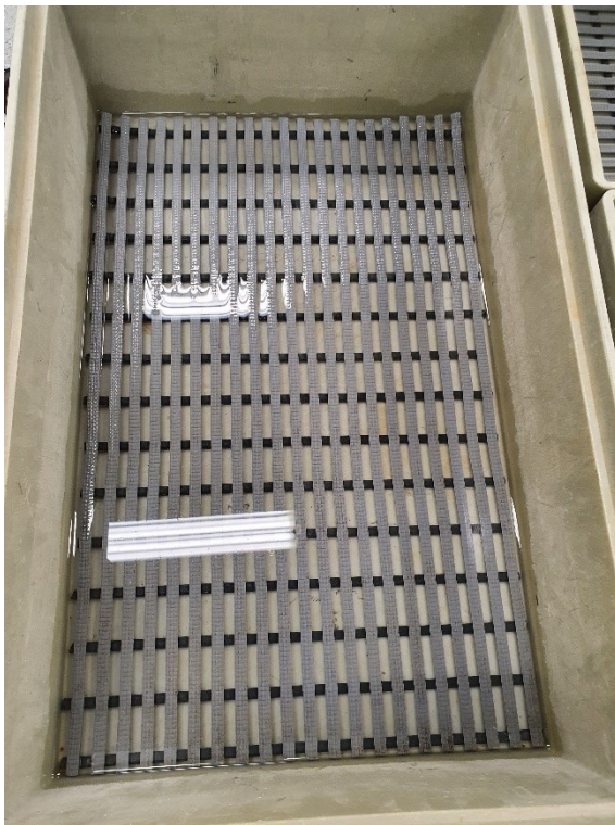
Kuva 41. Nystyräinen kumiritilä asetettiin imeytysastian pohjalle pitämään kappaleet irti astian pohjasta.
