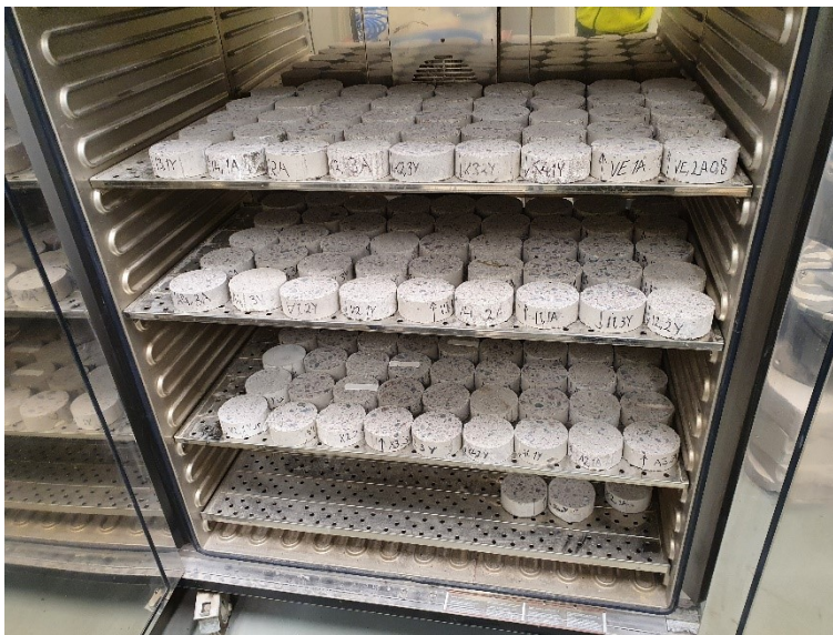
Kuva 40. Koekappaleista sahattujen kappaleiden kuivaus tuuletetussa lämpökaapissa.
