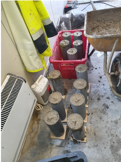
Kuva 31. Betoni-asemalla valmisbetonista valetut koekappaleet muoteissa.
