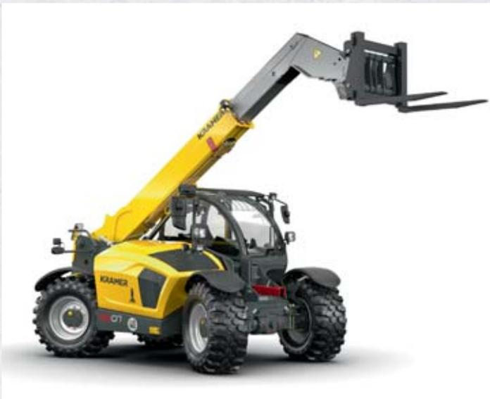
**KRAMER 5007** – Die Load Sensing Hydraulik gepaart mit dem Kramer ecospeed Fahrtrieb steigert die Produktivität enorm. Der Teleskoplader ist mit einem 136 PS Deutz Motor ausgestattet und erreicht eine Hubkraft von 4,8 t auf eine Stapelhöhe von 7 m.
