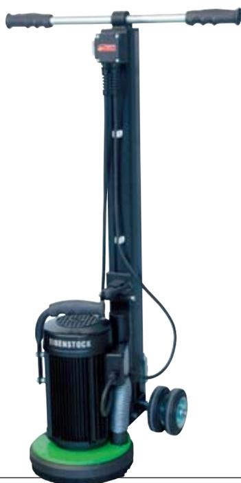
**Ausführung:** Mit Einphasen-Wechselstrommotor • Segment der Schutzhaube abnehmbar und Handgriff verstellbar • Schleifarbeiten bis unmittelbar an die Kante der Bearbeitungsfläche • **Bürstenkranz:** hohe Absaugleistung für staubarmes Arbeiten • **Höhenverstellbares** Fahrwerk • **Neigungsverstellbares** Bodenführungsgestell • Zusatzhandgriff am Motor
