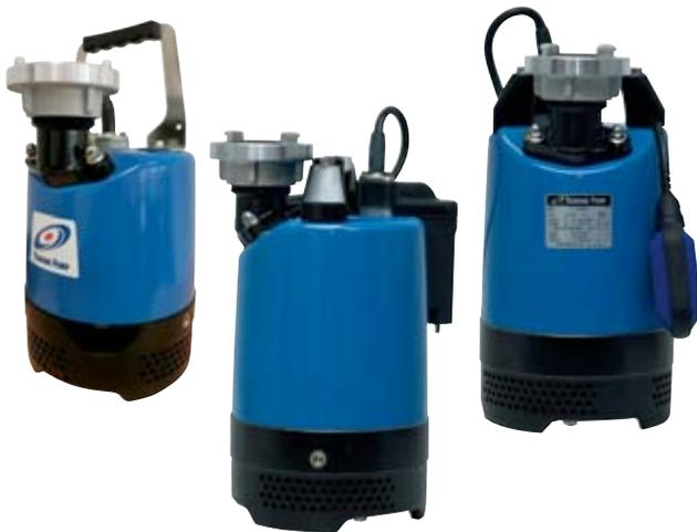
**Ausführung:** Robuste Schmutzwassertauchpumpe • Auslassöffnung oben • Trockenlaufsicher (halbgetaucht oder im Schlürfbetrieb) • Eingebauter Motorschutz • Schutzart **IP68** • Motorgehäuse aus Aluminiumdruckguss • **Fördermedium:** Regenwasser, sandhaltiges Wasser, Grundwasser • **Siebloch:** Ø 6 mm • **Druckbeständigkeit:** 10 m (LB-1500 und LBA-1500, 25 m) • **Kabellänge:** 10 m
