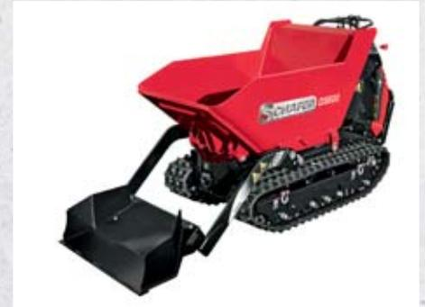
**DS 600 D** – Effiziente Beladung durch eine stabile und hydraulische Selbstladeeinrichtung.
