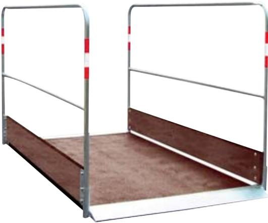
**Ausführung:** Für den sicheren Übergang über Gräben und Kanäle, aus verzinktem Stahlgestell • Mit Auffahrrampe für Rollstühle, Kinderwagen etc. • Holzbelag und Bordbrett bestehen aus mehrfach beschichteter Reinholzplatte • Rundum beschichtet mit **rutschfestem Belag**, wetterfeste Imprägnierung garantiert lange Haltbarkeit • Die Seitengeländer sind mit rot-weiß-roten Reflektorstreifen ausgestattet • Die Geländer sind herausnehmbar • **Tragfähigkeit: 150 kg/m<sup>2</sup>**
