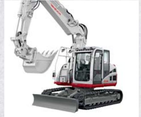
**TB 2150 R CM/CV – starke Hubkraft durch fix an der Kabine montiertem Ausleger** Extrem produktiv, absolut exakt und äußerst komfortabel. Lieferbar in zwei Auslegervarianten: mit Verstellausleger CV und Monoblock CM.
