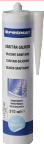
**Ausführung:** Hochwertiger, nach Aushärtung dauerelastischer, einkomponentiger Fugendichtstoff auf Silikon-Basis • **Acetatvernetzend** • Farbecht, witterungs- und UV-beständig • **Verarbeitungstemperatur:** Umgebung +5 °C bis +40 °C / **Haftfläche** +5 °C bis +35 °C • **Temperaturbeständigkeit:** -60 °C bis +120 °C
