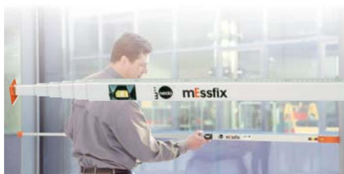
**Ausführung:** Teleskopmessstab zum Messen lichter Maße • Libellen zur horizontalen und vertikalen Ausrichtung des Teleskopmessstabes • Ablesung der Messergebnisse durch **Analoganzeige im Sichtfenster** • Maßband und die Aufwickelvorrichtung halten auch unter extremen Beanspruchungen stand
