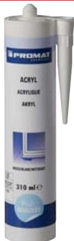
**Ausführung:** Plasto-elastischer, einkomponentiger Dichtstoff auf Acrylatdispersions-Basis • Farbecht, witterungs- und UV-beständig • Nach Aushärtung anstrichverträglich nach DIN 52452 • Maximale Gesamtverformung 7,5 % • Lösemittel- und silikonfrei • **Verarbeitungstemperatur:** +5 °C bis +30 °C • **Temperaturbeständigkeit:** -20 °C bis +80 °C
