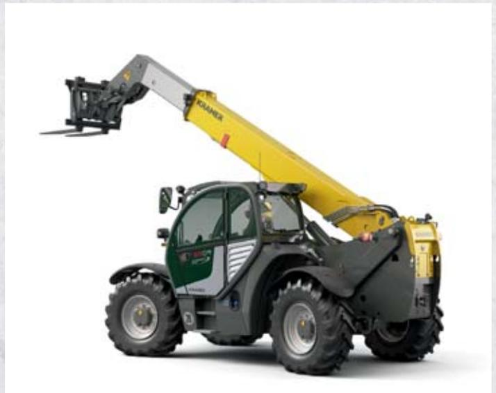
**KRAMER 5509** – Der Kramer Teleskoplader 5509 überzeugt im täglichen Einsatz durch sparsamen Kraftstoffverbrauch bei hohem Drehmoment und enormen Hubkräften bei bis zu 8,75 m Stapelhöhe.
