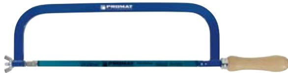
**Ausführung:** Aus Flachstahl, 18 x 8 mm • Pulverbeschichtet • Mit unverlierbaren Spannstiften nach DIN 6473 • Mit Buchenholzheft • Lieferung inkl. Bimetall-Sägeblatt
