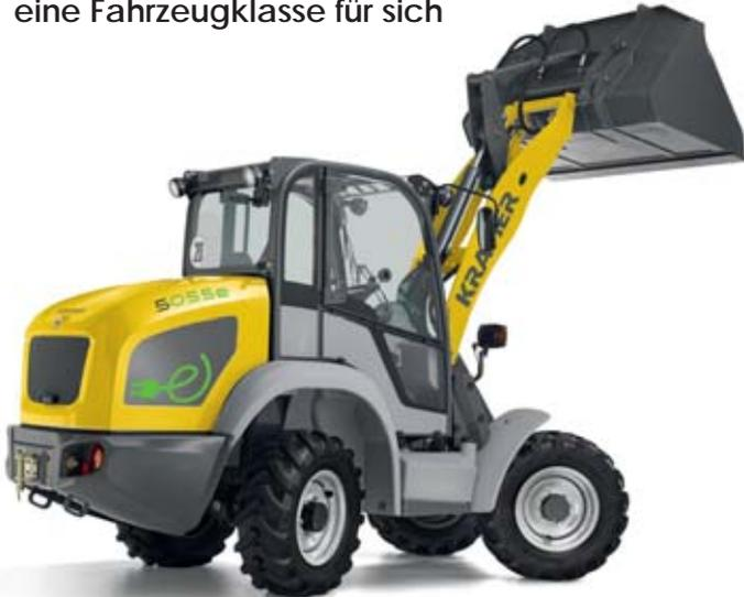
CO<sub>2</sub>-Emissionen, Lärm und Rußpartikel von Dieselmotoren waren gestern – der Kramer 5055e ist der erste allrad-gelenkte vollelektrisch betriebene Radlader. Neu ist der kosteneffiziente und vor allem emissionsfreie Elektroantrieb, der es möglich macht in Gebäuden und Lärmsensiblen Bereichen zu arbeiten. Der 5055e ist sehr kompakt und dabei aufgrund der Allradlenkung äußerst wendig. Für den Fahrtrieb ist ein Elektromotor verbaut, der hohe Leistung bei guter Auflösung zur Verfügung stellt.
