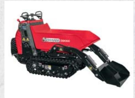
**DSK 800 D** – Effizient bei der Arbeit durch hydraulische Selbstladeeinrichtung mit drehbarer Ladeschaufel.
