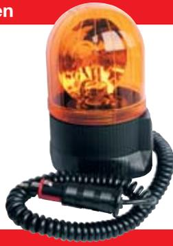
**Ausführung:** Magnetsockel mit zwei Magneten, Spiralkabel und Stecker für Zigarettenanzünder • Funkentstör-Filter • Metallisierter Stahl-Spiegel mit Auswucht-Gegengewicht und Rutschkupplung für manuelle Drehung • Blinkfrequenz: 160+/-30 min. • Euro-Norm: EUR A1 E2 0090121
