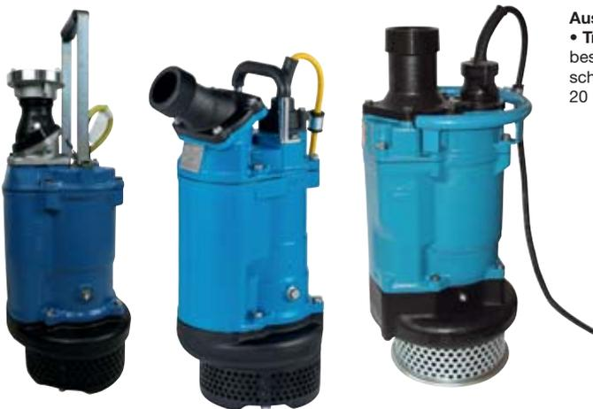
**Ausführung:** Schmutzwasserpumpe in Gußeisenausführung • Auslaßöffnung oben • **Trockenlaufsicher** (halbgetaucht oder im Schlürfbetrieb) • Alle verschleißintensiven Teile bestehen aus Gußeisen • Bis zu 25 m Eintauchtiefe • Schutzart **IP68** • Eingebauter Motorschutz • **Fördermedium:** Regenwasser, sandhaltiges Wasser, Grundwasser • **Kabellänge:** 20 m
