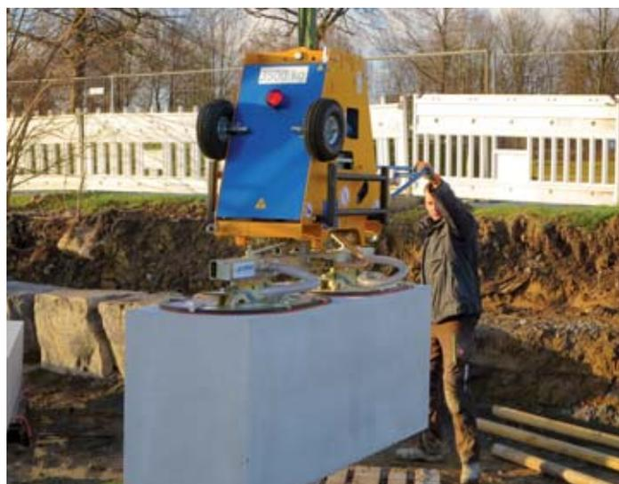
**Ausführung:** Mit integriertem Kettenfach und Lastsicherungskette • Ansaugen und Ablösen durch komfortable Tastenbetätigung am Bedienbügel • Eingebauter **Betriebstundenzähler** • Mit Einstecktasche für Staplerzinken zum Transport und zur Verlegung • Durch **galvanische Verzinkung** dauerhafter Oberflächenschutz
