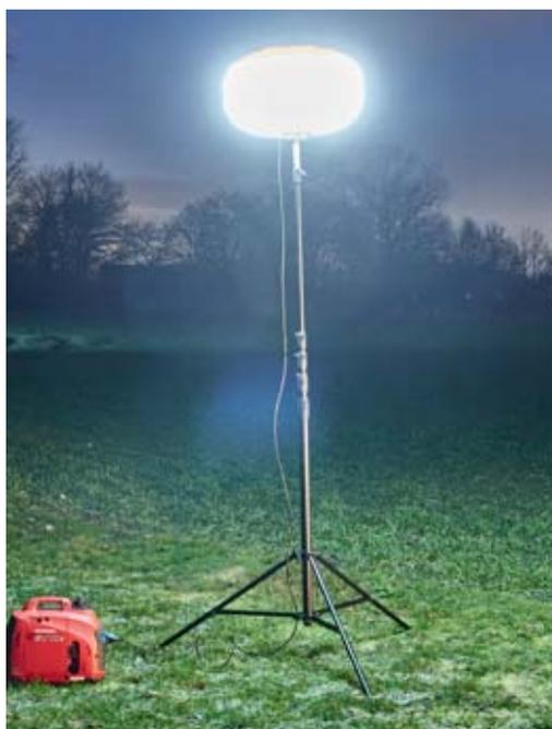
**Ausführung:** Aluminium Trägerkonstruktion, vibrations- und erschütterungsresistent • Blendfreie, diffuse und homogene Lichtverteilung • 360° Ausleuchtung ohne Schlagschatten • Die Ballonhülle besteht aus einem weißen, lichtdurchlässigen Nylongewebe und einem farbigen, innen beschichteten Reflektor • Die Hülle ist reißfest und wasserabweisend • Schutzklasse **IP 54**
