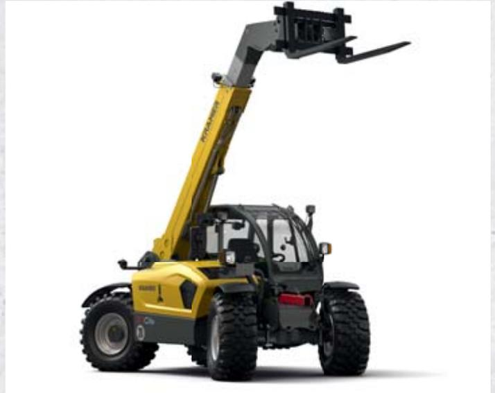
**KRAMER 2706** – Die 2 Meter x 2 Meter-Maschine, kraftvoller Motor und fast 6 Meter Hubhöhe
