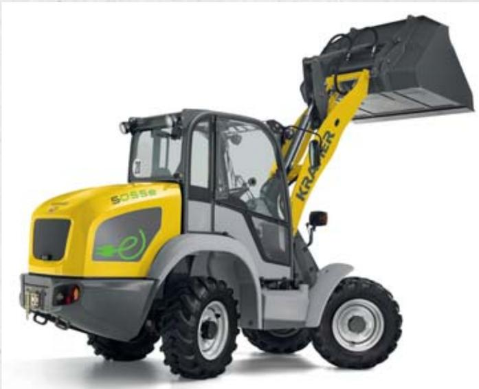
**KRAMER 5055e** – Der vollelektrische Lader bringt zukunftsorientierte Technik, geringe Wartungskosten und bis zu 5 Stunden Laufzeit bei vollem Akku mit sich. Er ist ideal geeignet für Arbeiten in Lagerhal-len, Tunnel und Innenstädten.
