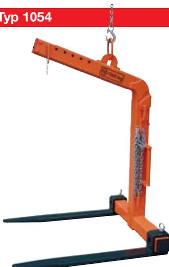
**Ausführung:** Mit automatischem Gewichtsausgleich gegen Federdruck • Stufenlos verstellbare Weite durch manuelle Zinkenverschiebung • Verstellbare Nutzhöhe durch Absteckbolzen • Mit Sicherungskette • Zinken aus Vollmaterial
