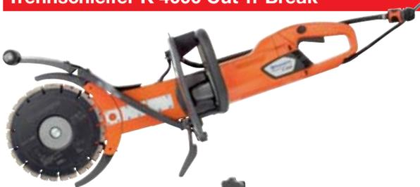
**Ausführung:** Der lange Körper und die doppelten Trennscheiben ermöglichen eine Schnitttiefe von bis zu 400 mm • Einzigartige Cut-n-Break Methode ermöglicht sich schrittweise bei geringen Werkzeugkosten durch das Material zu arbeiten • Doppelte Trennscheiben mit sehr stabilem Kern und hervorragender Schnittleistung sind im Lieferumfang enthalten • Der verstellbare Trennscheibenschutz ermöglicht es, nah an Wänden und Boden zu arbeiten
