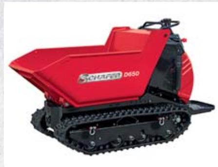
**D 650 D** – Lange, robuste Laufwerke, ein pendelnd gelagertes Laufrollenpaar und ein vorn und hinten abgeschrägtes Laufwerk sorgen für optimale Steigfähigkeit und erleichtert das Überwinden von Hindernissen.
