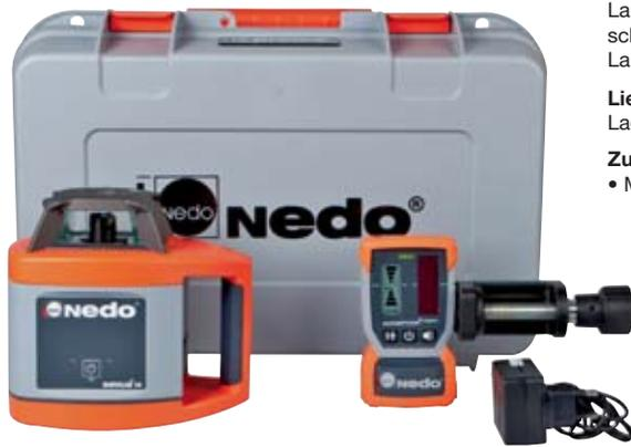
**Ausführung:** Vollautomatischer **Horizontallaser** für den Außeneinsatz • Selbstnivellierbereich  $\pm 5^\circ$  mit motorischer Horizontierung • **Laserklasse 2** • Automatische Höhenüberwachung stoppt den Laser bei einer starken Erschütterung • Strahlwassergeschütztes Gehäuse gem. **IP 65** • Rotorschutz aus Aluminium-Druckguss und bruchsicherem Glas • NiMH Hochleistungsakkus für lange Laufzeit
