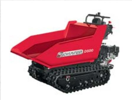
**D 500 D** – Belastbar und wendig durch geringe Abmessungen und Maschinengewicht bei großer Zuladung (500 kg).
