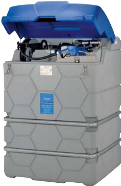
**Ausführung:** Mit integrierter Auffangwanne • Optische Leckageanzeige • Befüllanschluss mit 2" Trockenkupplung • Überfüllsicherung • Entlüftungsklappe • Füllstandsanzeiger • Elektrische Pumpe 230 V, 35 l/min • Automatik Zapfpistole und Zapfpistolenhalter
