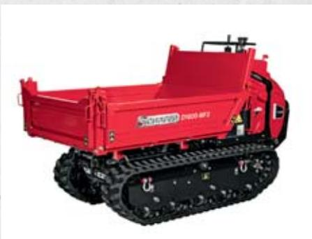
**D 1600-MF3** – Flexibel hoch drei durch nach drei Seiten hydraulisch kippbare Mulde und eine Ladefläche optimal zum Transport von Europaletten mit den Maßen 800 x 1200 mm.
