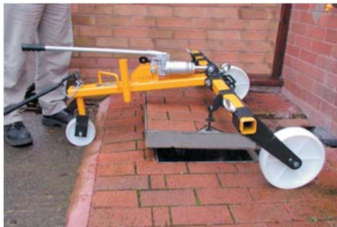
**Ausführung:** Galvanisch verzinkt • 1500 kg Losreißkraft • Lässt sich mit wenigen Handgriffen zerlegen • Ohne Schlüssel und Traversen
