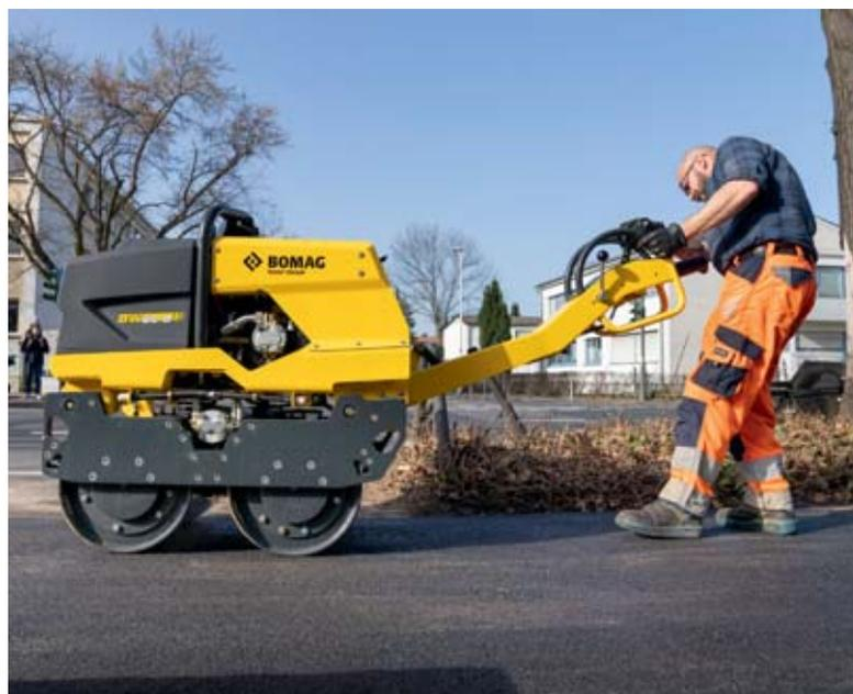
**Ausführung:** Handgeführt • Hydrostatischer Fahr- und Vibrationsantrieb
