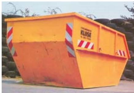
**Hinweis:** Container müssen mit Warnmarkierungen aus Folie RA 2 nach DIN 67520 Teil 2 gekennzeichnet werden
