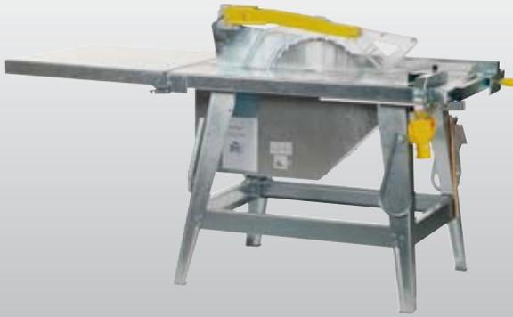
**Ausführung:** Nach neuer Norm EN 1870-19 • Mit Sicherheitsschutzhaube und Tischverlängerung • Abklappbarer Queranschlag • Führungselemente geschützt unter dem Tisch angebracht • **Inklusive schallgedämpften Hartmetallsägeblatt** • Feuerverzinktes, verwindungsfestes Maschinengestell • Motor mit Magnetbremse, bremst das Sägeblatt unter 10 Sekunden • 4 Kranösen • Parallelanschlag mit zwei Anlegekanten • Drehstrommaschinen serienmäßig mit Phasenwender
