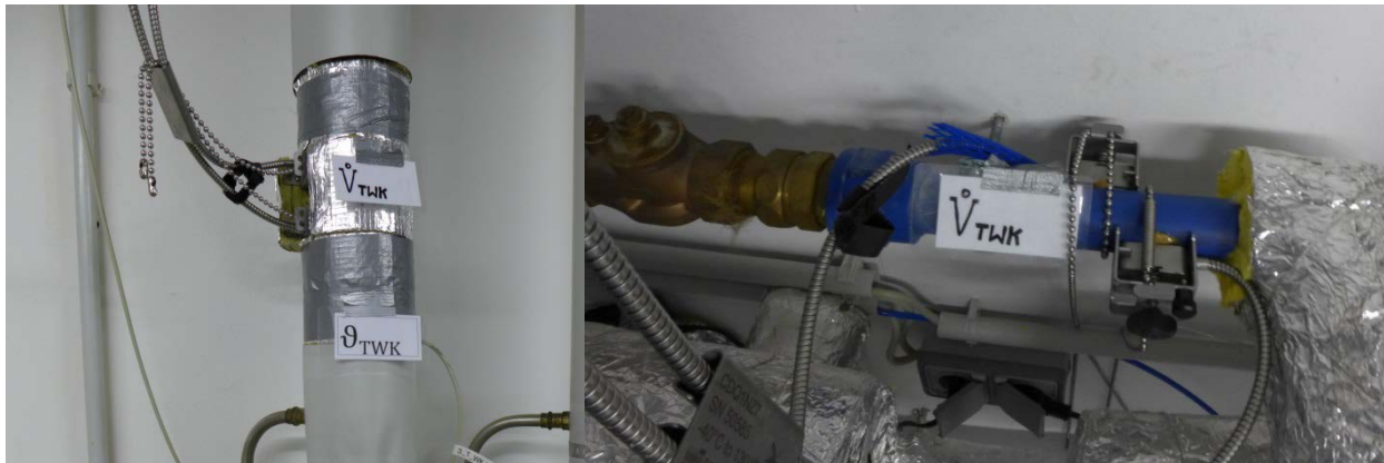
Abb. 2-6 Durchflussmessung Volumenstrom, Links: Standard-Reflex-Messung, Rechts: Durchstrahl-Messung bei PP-Verbundrohr mit kleinem Durchmesser
