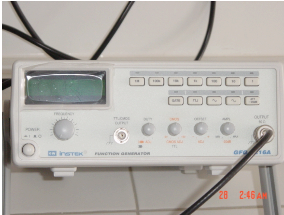
Εικόνα 5.7 Γεννήτρια συχνοτήτων με την οποία καθορίζουμε τη συχνότητα και το είδος του μήκους κύματος
