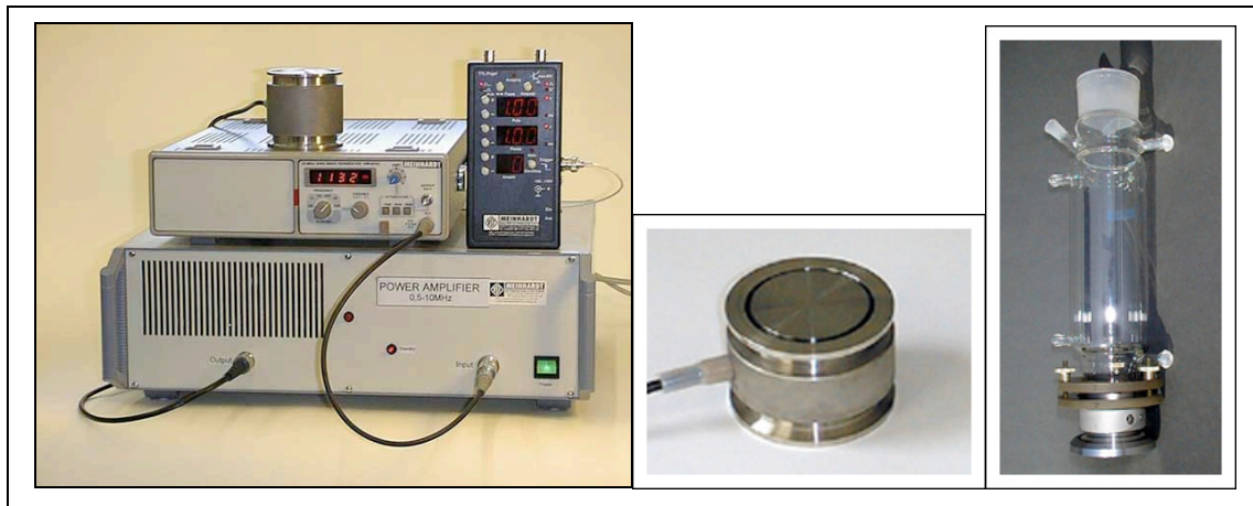
Εικόνα 5.1 α) MFLG – transducer E/805/T/M, β) transducer E/805/T και γ) T02 glass reactor
