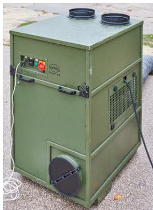
10. kép: Mobil hűtő-fűtő berendezés, készítette a szerző, forrás: Gamma Zrt.
