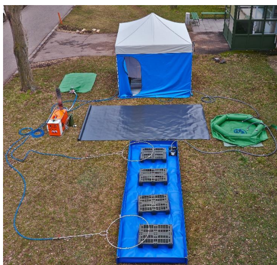
6. kép: A KML járművekben alkalmazott Beavatkozó Mentесítő Készlet (BMK), készítette a szerző, forrás: Gamma Zrt.
