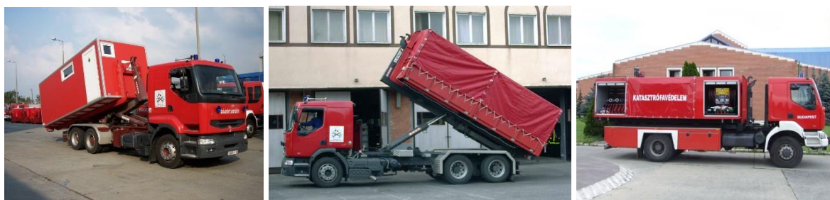
3. kép: Konténerszállító gépjármű habbal-porral oltó, légzőbázis, univerzális platós konténerrel, forrás: [109] [115]
