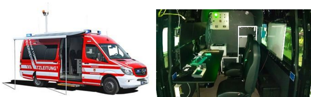
16. kép: Zárt áruszállítóból kialakított kivitel, forrás: [204].
