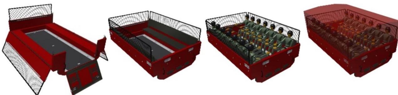
12. ábra: Platós nyitott személyszállító és nyitott ponyvás felépítmények, készítette a szerző, forrás: saját munka.
