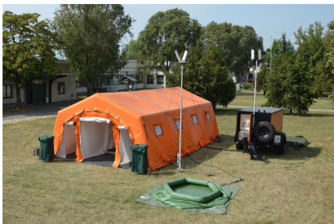
5. kép: Személyi mentesítő felszerelés, (SZMF-U) utánfutóba integrált RBA 70KVi modullal, készítette a szerző, forrás: Gamma Zrt.
