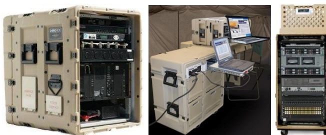
12. kép: Málhaként szállított MVP főegységek, forrás: M. Schall GmbH.
