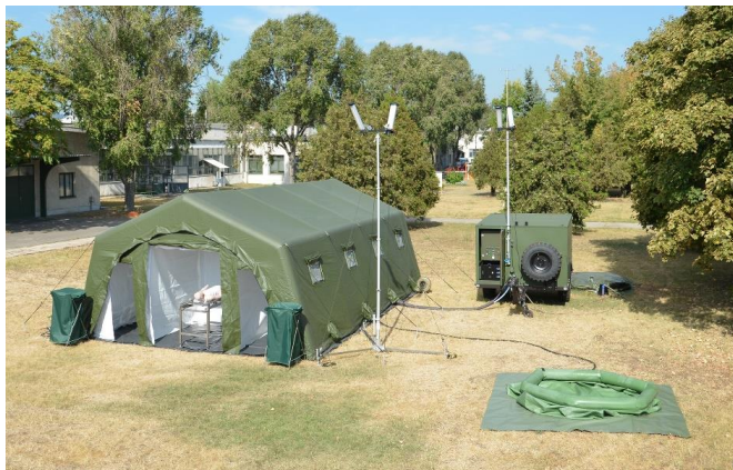
7. Kép: Sebesült mentésítő rendszer (SMR-U) hajlékonyfalú víztartályokkal telepítve, készítette a szerző, forrás: Gamma Zrt.
