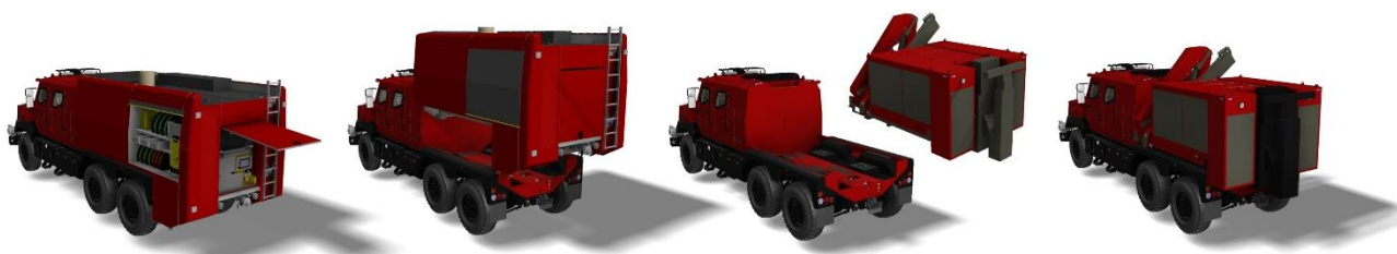
9. ábra: A duplafülkés, többcélú katasztrófavédelmi képességekkel ellátott KOMONDOR gépjármű felépítményrendszerek cseréje, készítette a szerző, forrás: Gamma Zrt.
