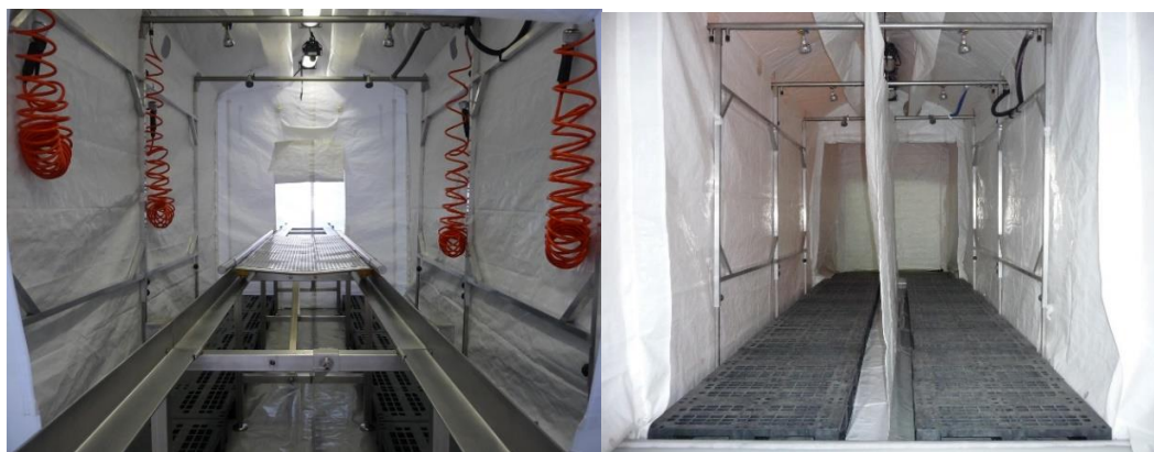
8. kép: SMR sátor középső sorának berendezése kétféle sebesült/személyi mentesítési alkalmazásnál, készítette a szerző, forrás: Gamma Zrt.
