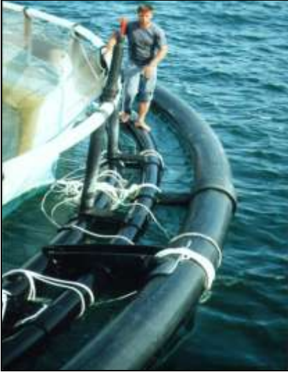
Resim 4. Açık denizde kullanıma uygun yüksek yoğunluklu polietilen kafesler.
