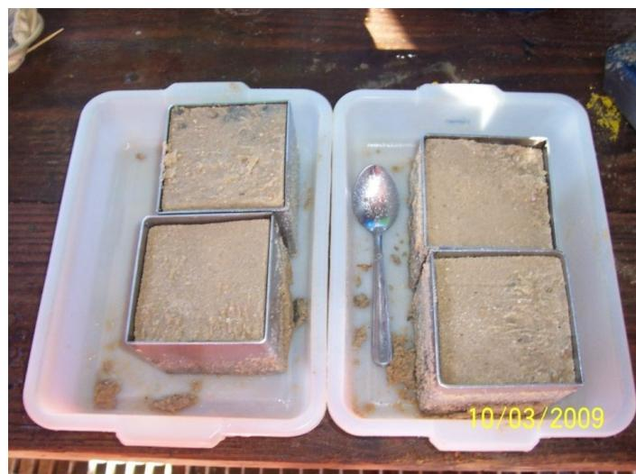
Figura 4. Gabaritos de aço utilizados na coleta da macrofauna bentônica na desembocadura do Rio Paraíba do Sul.
