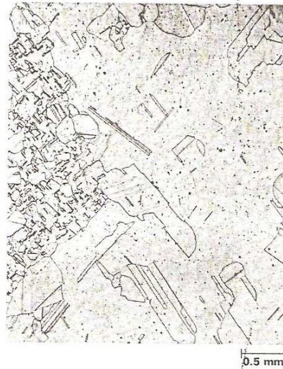
Figura 24. Microestrutura com crescimento anormal de grão e recristalização secundária de um aço inoxidável austenítico AISI 304.
