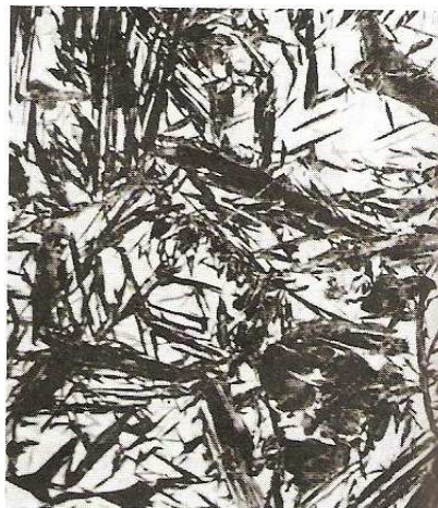
Figura 1. Microestrutura de um aço inoxidável martensítico em forma de agulhas (Callister, 2007).
