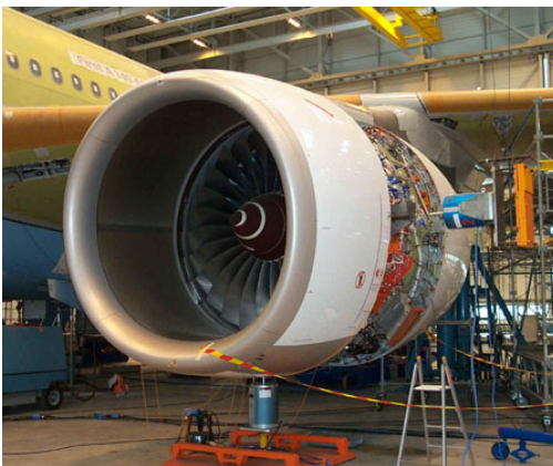
Figura 2.4: Distribución por posición fija: ensamble de un avión Airbus A340/600 en la planta de Airbus en Toulouse (Francia).
