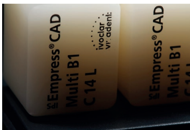
Figura 2 - Blocos de vidrocerâmica reforçada por leucita. Observe a gradação de saturação de cor e translucidez, que permite a fabricação de restaurações com melhor resultado estético. Fonte: Os autores.
