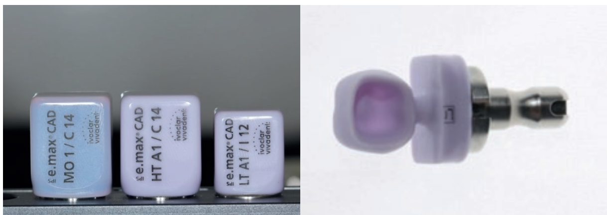
Figura 4 - À esquerda, blocos de dissilicato de lítio em dois tamanhos e três variações de opacidade. Os blocos pré-cristalizados apresentam a cor azul, as características finais de resistência, cor e translucidez são atingidas após a cristalização a 850° C. À direita, uma coroa fresada a partir de um bloco de dissilicato de lítio. Fonte: Os autores.
