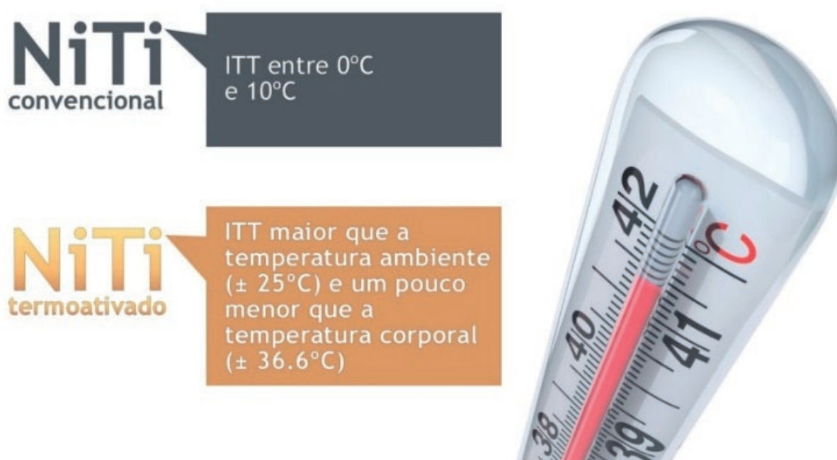
Figura 7 – Diferença no ITT (Intervalo de Transformação Térmica) entre as ligas de NiTi convencionais (M-NiTi) e as ligas termoativadas. Fonte: Berger e Waram (2007).
