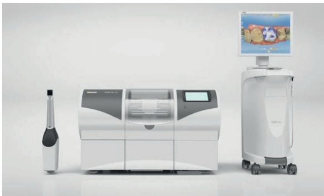
Figura 1 - Os três componentes do sistema CEREC. À direita, unidade de processamento de imagens e projeto (CAD); no centro unidade fresadora; à esquerda scanner intraoral. Fonte: Os autores.
