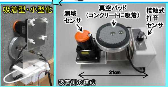
開発した吸着型小型計測ユニット
