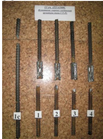
Рис.1. Вид сварных соединений Ø 25мм после испытания
