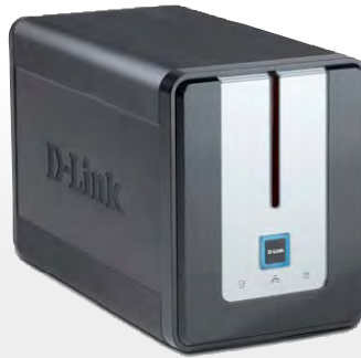
Typisches Home-NAS: Meistens fasst das Gehäuse zwei SATA-Festplatten, die sich einfach einschieben lassen und dann einrasten.
