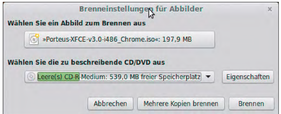
Bootfähige CDs und DVDs mit Brasero: Das Programm fordert lediglich die Navigation zur ISO-Datei und einen Klick auf „Brennen“. Ähnlich einfach funktioniert das Tool Imgburn unter Windows.
