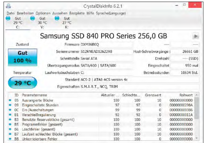
Mit CrystalDiskInfo behalten Sie den Zustand von herkömmlichen Festplatten und SSDs immer im Auge und können einen drohenden Ausfall rechtzeitig erkennen.
