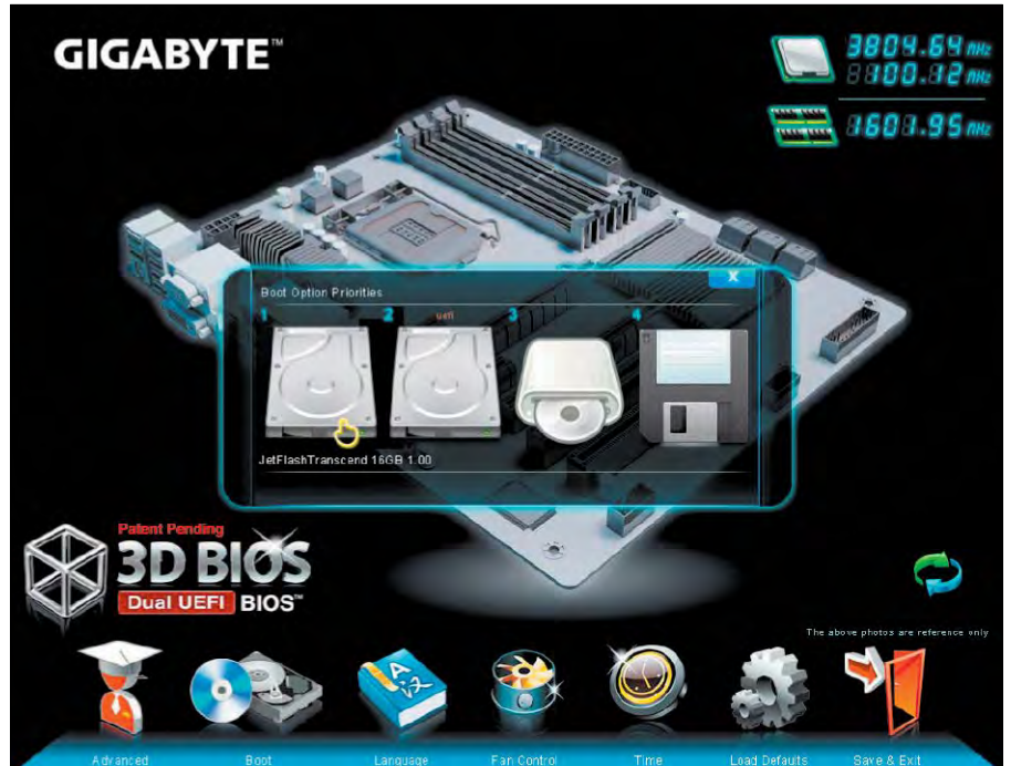
Bootreihenfolge einstellen: Sie können den mobilen Datenträger manuell über das Firmware-Bootmenü wählen oder – wie hier – das Medium dauerhaft an die erste Stelle setzen.
