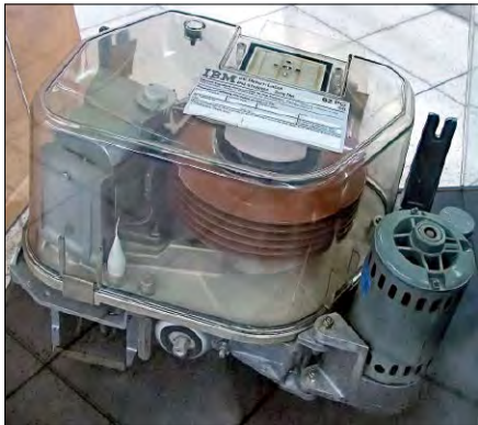
Lange her: Alte IBM-62-PC-Festplatte aus dem Jahr 1979 mit 6 x 8 Scheiben und insgesamt rund 65 MB Speicher. Heute würde der Speicherplatz gerade noch so für ein als MP3 gespeichertes Musikalbum reichen.
