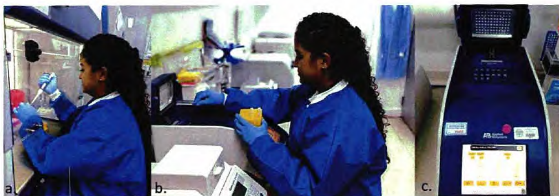
Figura 14. Proceso de preparación de la mezcla de reacción para PCR. (a. preparación del mix de la reacción, b. colocación de muestras en termociclador, c. termociclador utilizado para llevar a cabo el ciclado de la reacción de PCR).
