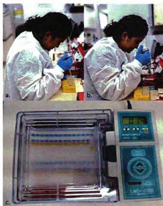
Figura 15. Proceso de electroforesis. Se realizó con la preparación de gel de agarosa al 1.5 % en Buffer TBE 1X, corrida electroforética a 60 Voltios por una hora. (a y b. carga de muestra, c. corrida de muestras en la cámara de electroforesis).
