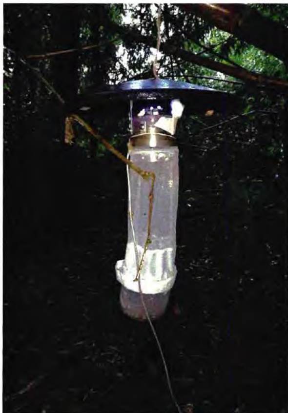
Figura 7. Trampa de Luz tipo CDC, utilizada para la captura de flebotomos. Foto por: Luisa Collado
