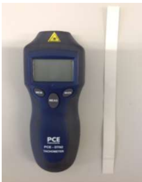
Figura 25. Tacòmetre digital PCE-DT62.
