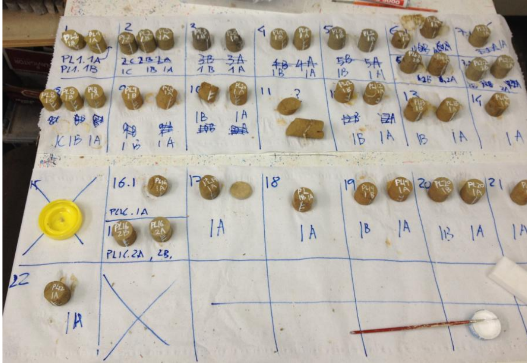
Fig 2.4 Las muestras cortadas. Se hecho en Laboratorio de Paleomagnetismo (CCiT UB-ICTJA CSIC)
