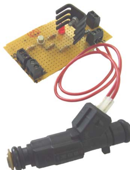
Fig. 5.32 Inyector de alta impedancia
