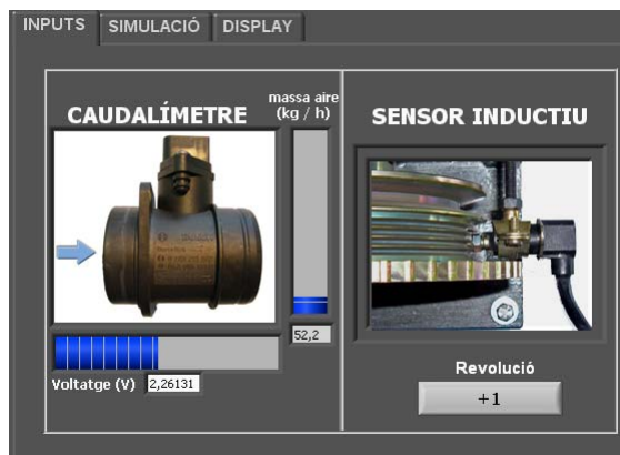
Fig. 6.2 Desplegable de “inputs”
