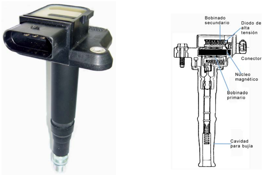
Fig. 4.43 Pipeta de encendido independiente, imagen real (Hitachi) y esquema [39]
