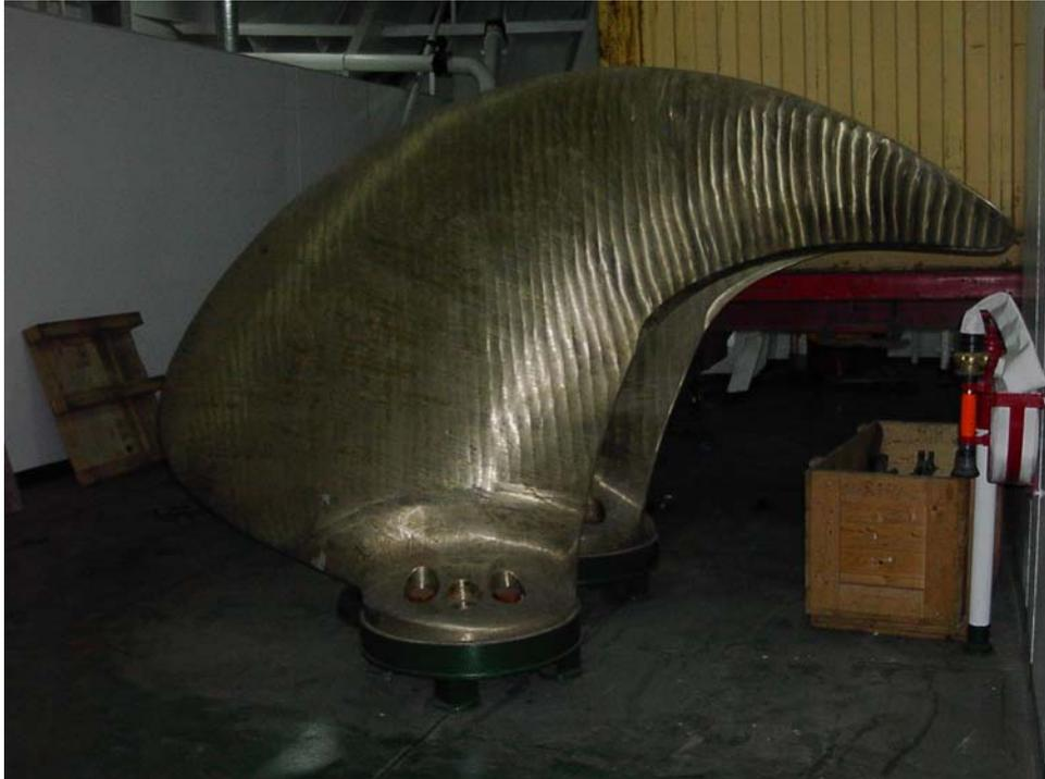
Imagen 23. Palas hélices propulsoras
