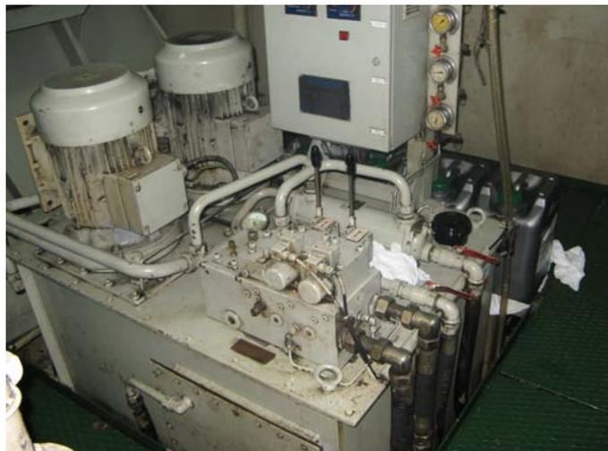
Imagen 25. Equipo de potencia hidráulica.
