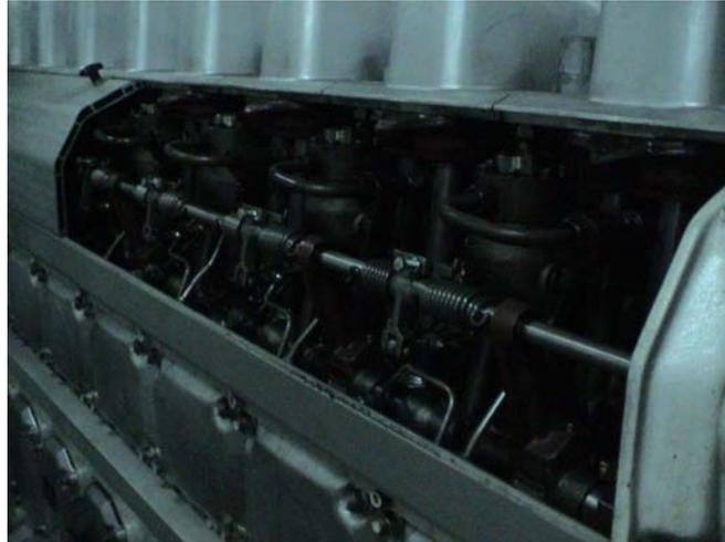
Imagen 23. Eje de distribuidores de combustible de los motores auxiliares.
