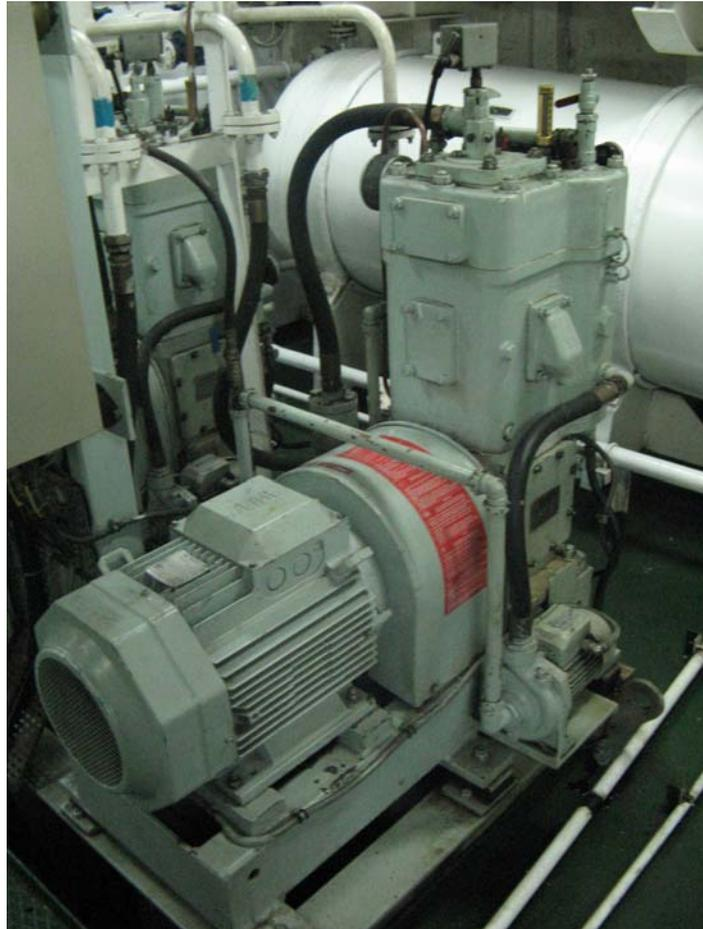
Imagen 45. Compresor de aire de arranque.
