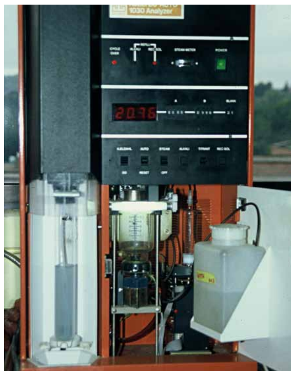
Figura 7.22. Kjeltec, aparato para la determinación de la proteína por el método de KJELDAHL.
