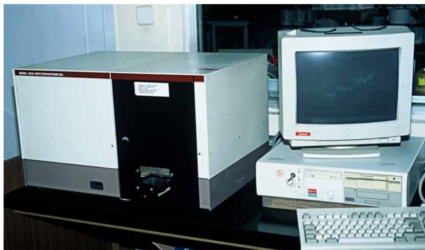
Figura 7.24. Espectrómetro de reflectancia en el infrarrojo cercano, NIR-Systems 6250, en el Laboratori Agroalimentari de Cabrils (Barcelona), compuesto por un emisor-detector de reflectancia, un microprocesador acoplado al mismo y un programa de software.
