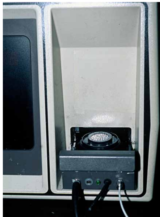
Figura 9.21. Detalle del sistema de presentación de la muestra en el espectrofotómetro InfraAlyzer 450 (Bran + Luebbe) de la Facultat de Veterinària de la Universitat Autònoma de Barcelona, apto tanto para muestras sólidas molidas como líquidas.
