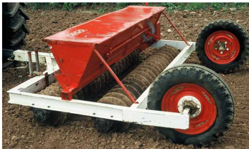
Figura 3.7. Sembradora de pratenses consistente en dos rodillos acanalados entre los cuales cae la semilla procedente de una tolva.
