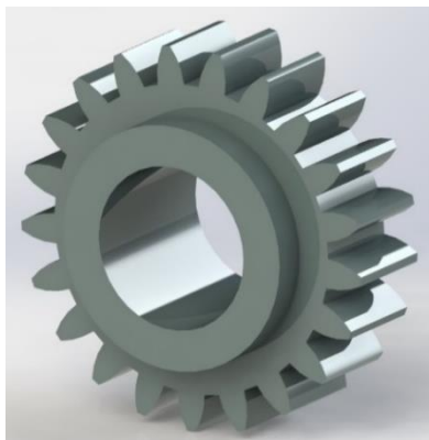
Ilustración 12. Vista del satélite
