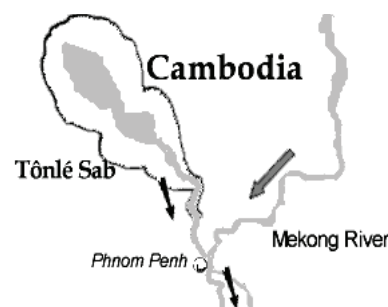
Fig. 5.3.3. Flujo de retroceso en la estación seca
