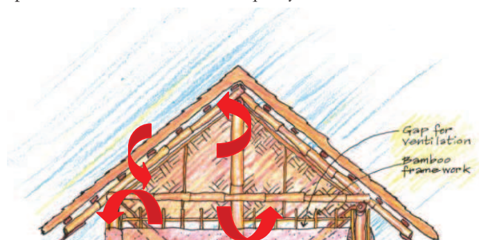
Fig. 5.5.62. Sistema de cubierta ventilada. Fuente: Adaptado de [5]
